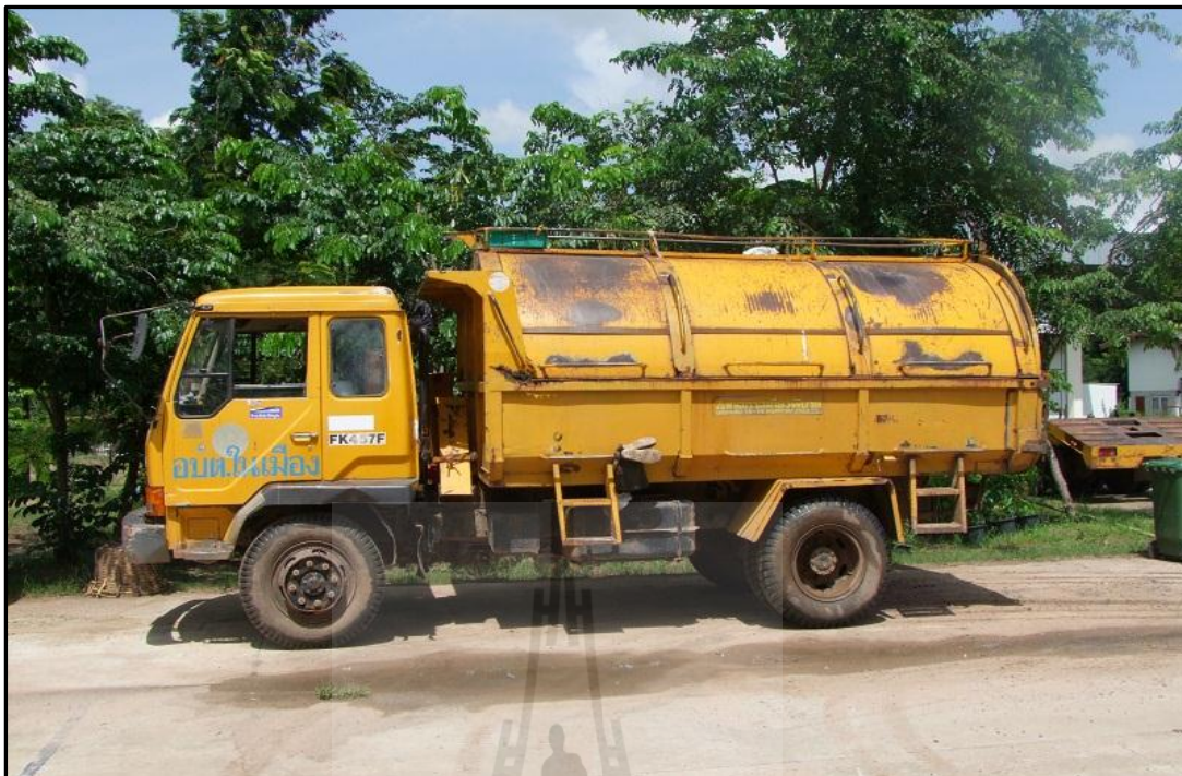
รูปที่ ก.3 รถบรรทุกขยะแบบอัดทำไม่ได้
