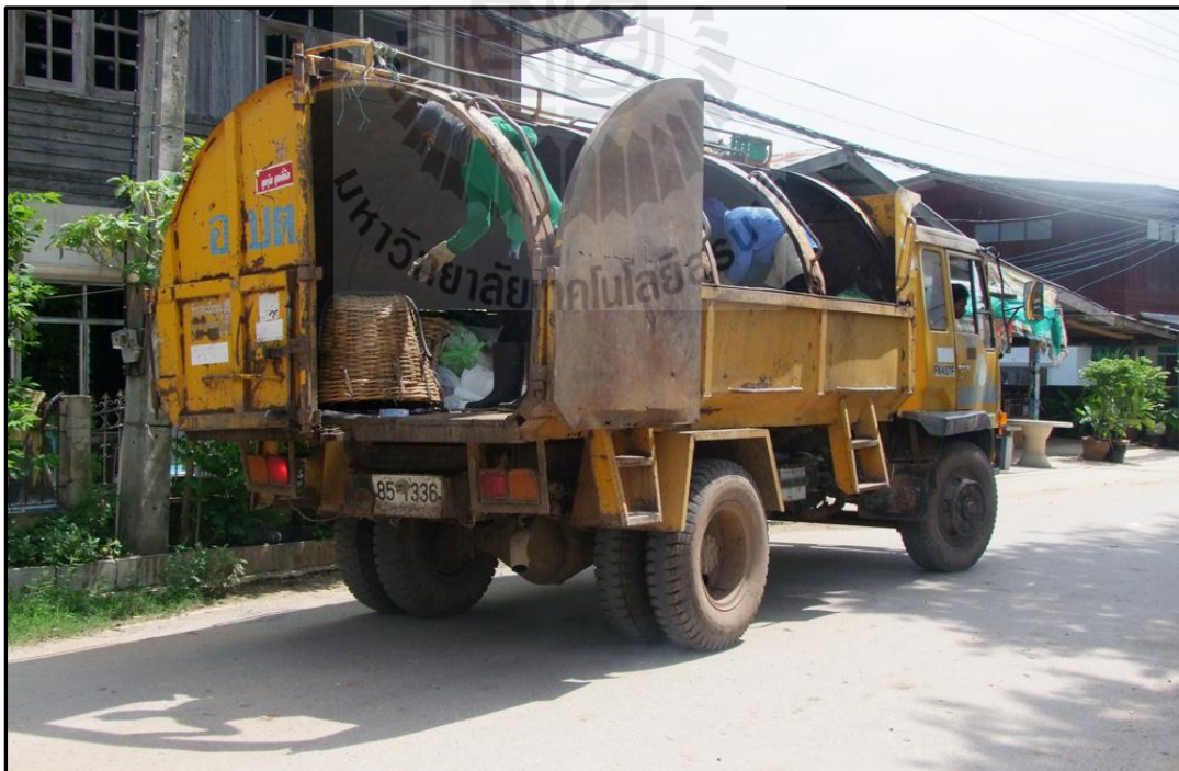
รูปที่ ก.4 รถบรรทุกขยะแบบอัดทำไม่ได้
