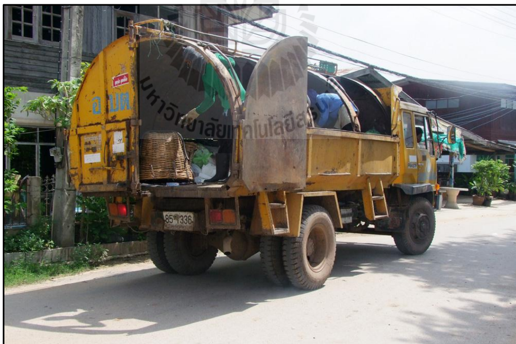
รูปที่ 3.7 รถบรรทุกขยะแบบอัดทำไม่ได้
