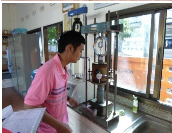
รูปที่ 3.10 การทดสอบเพื่อหาค่า ซี.บี.อาร์. (C.B.R.)
