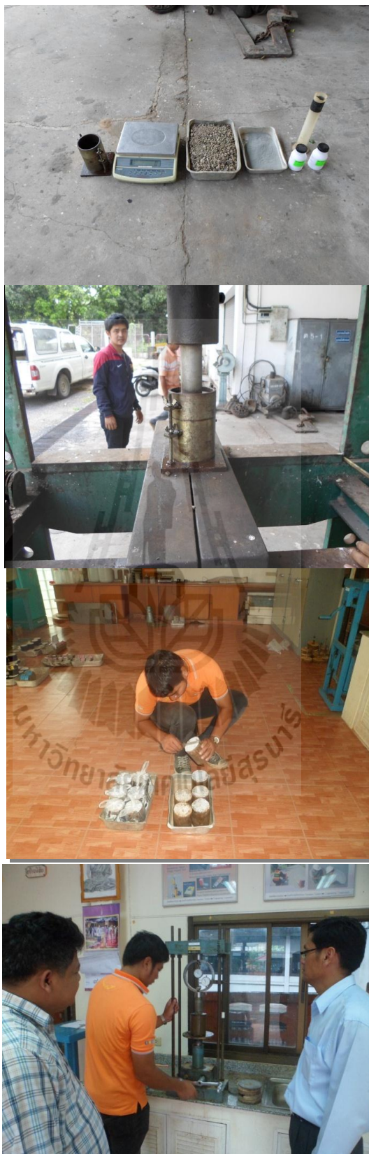
รูปที่ 3.12 การเตรียมตัวอย่างและการทดสอบกำลังรับแรงอัดแกนเดี่ยว
