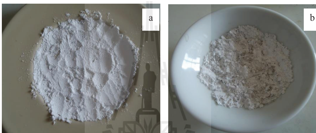
รูปที่ 4.4 ซีโอไลต์ NaY หลังจากการทำให้เอิบชุ่มด้วย (a) \text{CH}_3\text{COOK}/\text{CH}_3\text{COOH} และ (b) สารละลาย \text{CH}_3\text{COOK} และการแคลไซน์ที่ 400\text{ }^{\circ}\text{C} เป็นเวลา 3 ชั่วโมง
