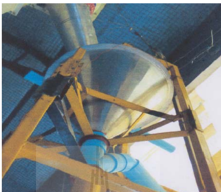
รูปที่ 3. 8 รูปถ่ายถึงพักข้าวเปลือกด้านบน
