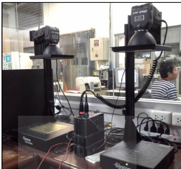
รูปที่ 5.9 เครื่องมือวัดช่วงอายุพาหะ บริษัท Sinton รุ่น WCT-120 จากศูนย์เทคโนโลยี อิเล็กทรอนิกส์และคอมพิวเตอร์แห่งชาติ(NECTEC)
