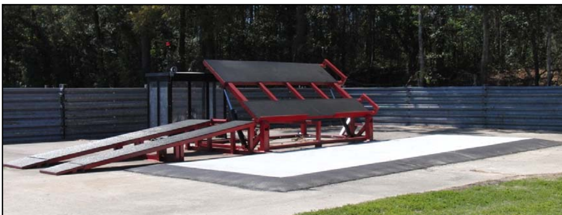
รูปที่ 2.26 พื้นเอียงที่ใช้ในการทดสอบรถพลิกคว่ำ
