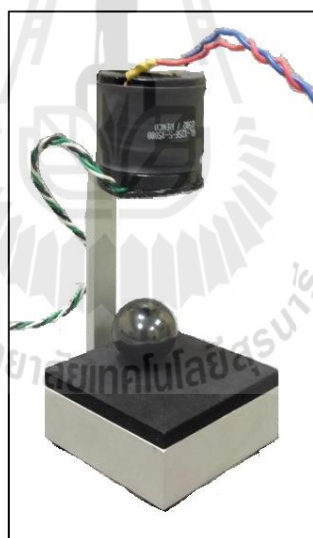
รูปที่ 5.1 อุปกรณ์สร้างสนามแม่เหล็กพร้อมแท่นวาง และลูกบอลแม่เหล็กถาวร
