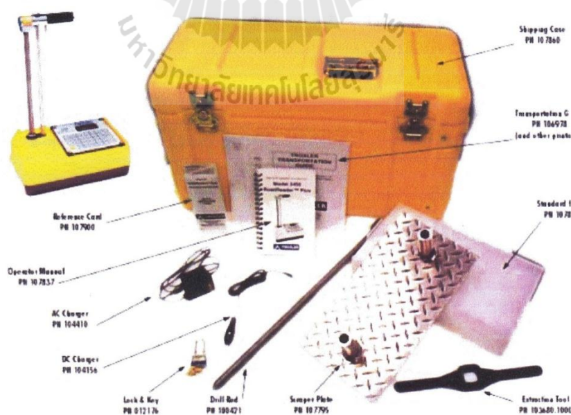
รูปที่ 2.41 ส่วนประกอบของชุดวัดความชื้นและความหนาแน่นของเครื่องมือ
