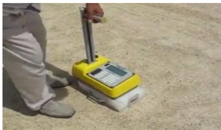
รูปที่ 2.43 การนำเครื่องทดสอบวางบนแผ่นบอรัคพาราฟินเพื่อทำ Standard count
