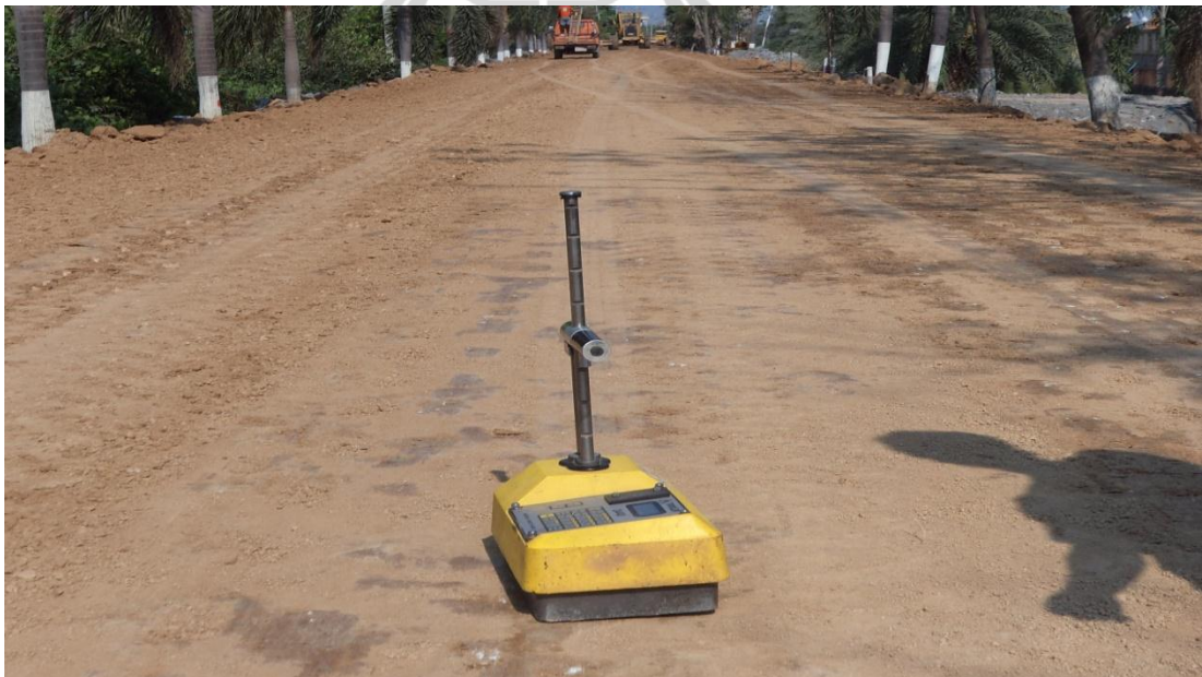
รูปที่ 3.3 การทดสอบความแน่นในสนามรอบที่ 15
