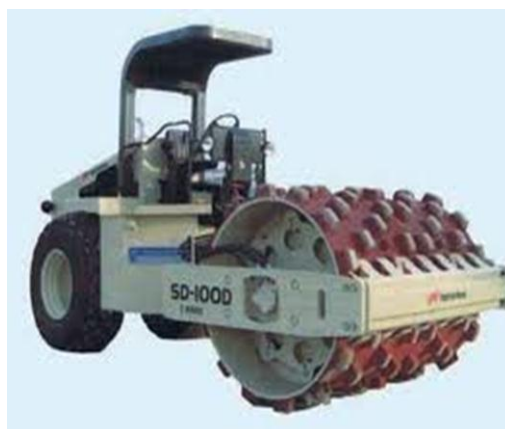
รูปที่ 2.34 รถบดสั่นสะเทือน (vibrating roller)
