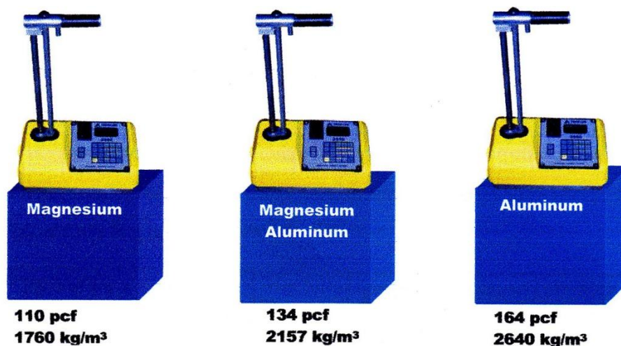
รูปที่ 2.46 การทำ Calibration ของเครื่องมือ โดยทดสอบบนวัสดุที่รู้ค่าความหนาแน่นที่แน่นอน
