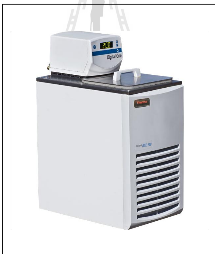
รูปที่ 4.20 เครื่องควบคุมอุณหภูมิ (ยี่ห้อ Thermo Scientific รุ่น NESLAB RTE 740)
