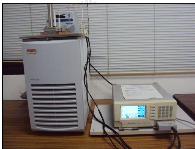
รูปที่ 4.24 การเชื่อมต่ออุปกรณ์สำหรับวัดสมบัติไดอิเล็กทริก
