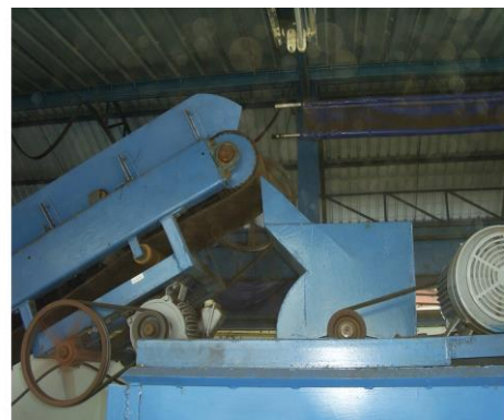
รูปที่ 4-13 การลำเลียงปุ๋ยโดย Belt Conveyor ผ่านเครื่องตี (Hammer Mill)
