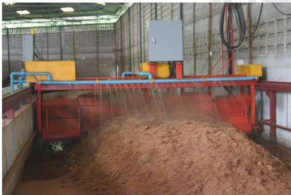
ก) การเติมอากาศโดยใช้ใบพลิกกลับกอง
