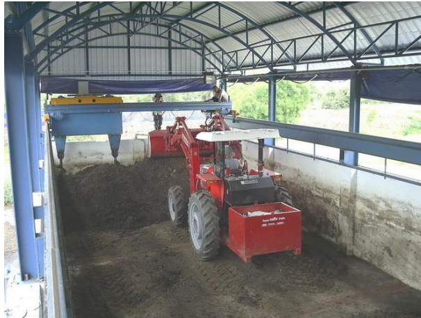
รูปที่ 4-7 การลำเลียงวัตถุดิบเข้าโรงผลิตโดยใช้รถแทรกเตอร์ (Loader)
