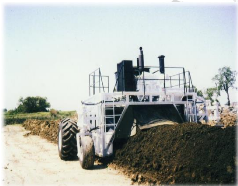
รูปที่ 2-4 รูปแบบการผลิตปุ๋ยอินทรีย์ แบบ Agitated Pile (Windrow)
