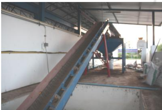
รูปที่ 4-13 การลำเลียงปุ๋ยโดย Belt Conveyor ผ่านเครื่องตี (Hammer Mill)
