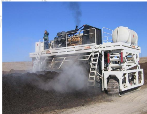
รูปที่ 2-4 รูปแบบการผลิตปุ๋ยอินทรีย์ แบบ Agitated Pile (Windrow)
