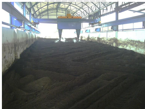
รูปที่ 4-8 การกลับกองปุ๋ยโดยใช้สกรูกลับกอง (Agitator)
