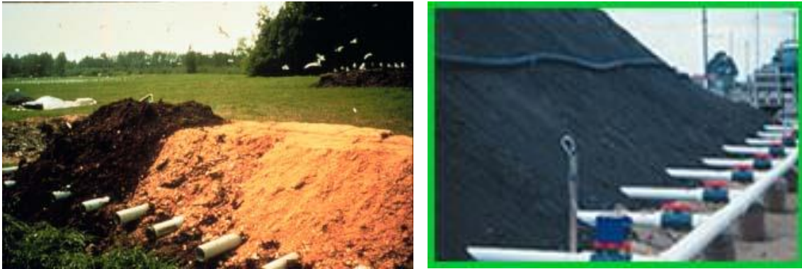
รูปที่ 2-5 รูปแบบการผลิตปุ๋ยอินทรีย์ แบบ Passive or Forced Aeration Static pile
