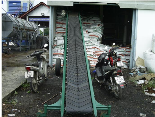
รูปที่ 4-15 การลำเลียงผลิตภัณฑ์เข้าโกดังเก็บโดยใช้สายพานลำเลียง (Belt Conveyor)
