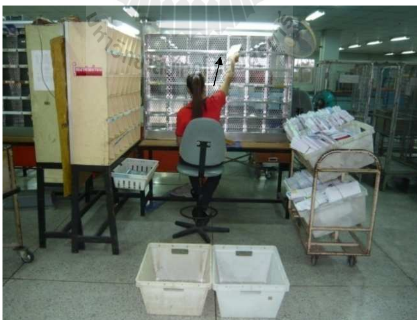
รูปที่ 3.12 การเอื้อมวางจดหมายใส่ช่องในระดับสูง
