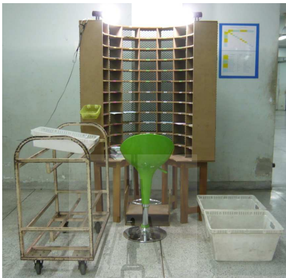
รูปที่ 4.12 แสดงภาพของสถานีงานตัดแยกจดหมายที่ทำการปรับปรุงใหม่
