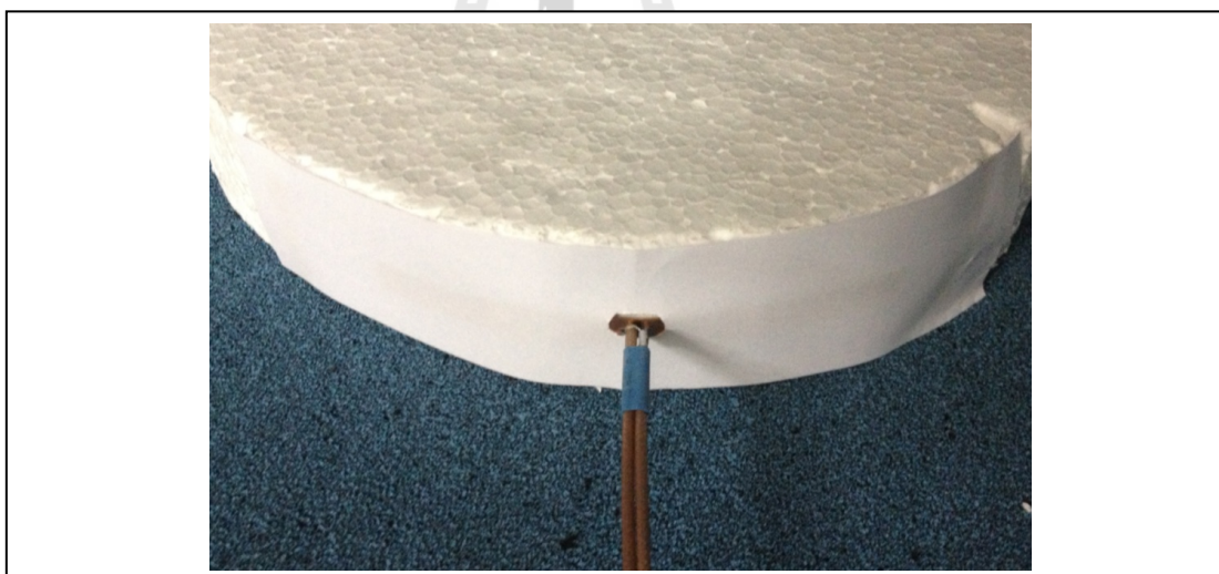
รูปที่ 4.15 สายอากาศไดโพลแบบแผ่นแบนหุ้มด้วยกระดาษวางบนโฟม EPS แบบโค้ง ขนาดความโค้ง 60 องศาหรือรัศมี 126 มิลลิเมตร
