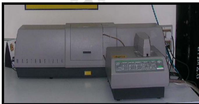
รูปที่ 3.1 เครื่องวิเคราะห์ขนาดอนุภาค Particle Size Analyzer
