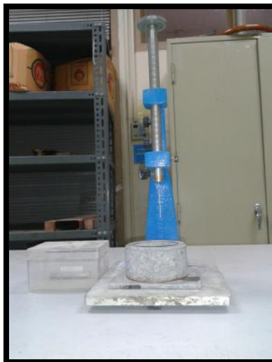
รูปที่ 3.3 เครื่องทดสอบความขึ้นเหลวปกติ Vicat Apparatus
