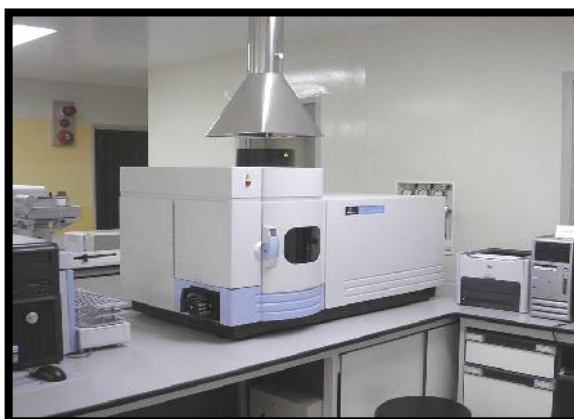
รูปที่ 3.6 เครื่องวิเคราะห์โลหะหนัก Inductively Coupled Plasma Spectroscopy (ICP)
