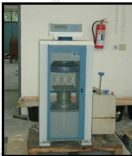
รูปที่ 3.4 เครื่องทดสอบกำลังอัด Compression machine
