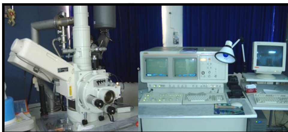
รูปที่ 3.2 เครื่องถ่ายภาพขยายกำลังสูง Scanning Electron Microscope (SEM)
