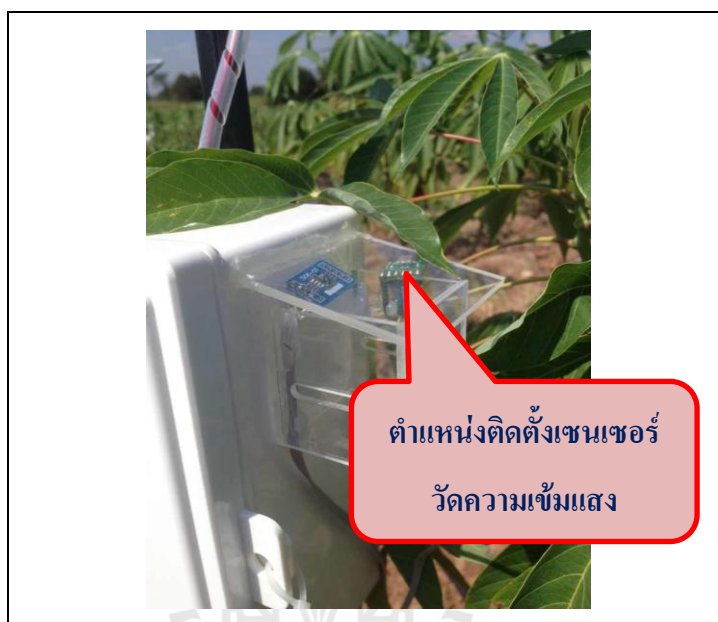
รูปที่ 3.20 การติดตั้งเซนเซอร์วัดความเข้มแสง
