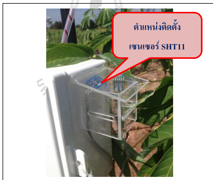
รูปที่ 3.19 การติดตั้งเซนเซอร์วัดอุณหภูมิและความชื้นสัมพัทธ์
