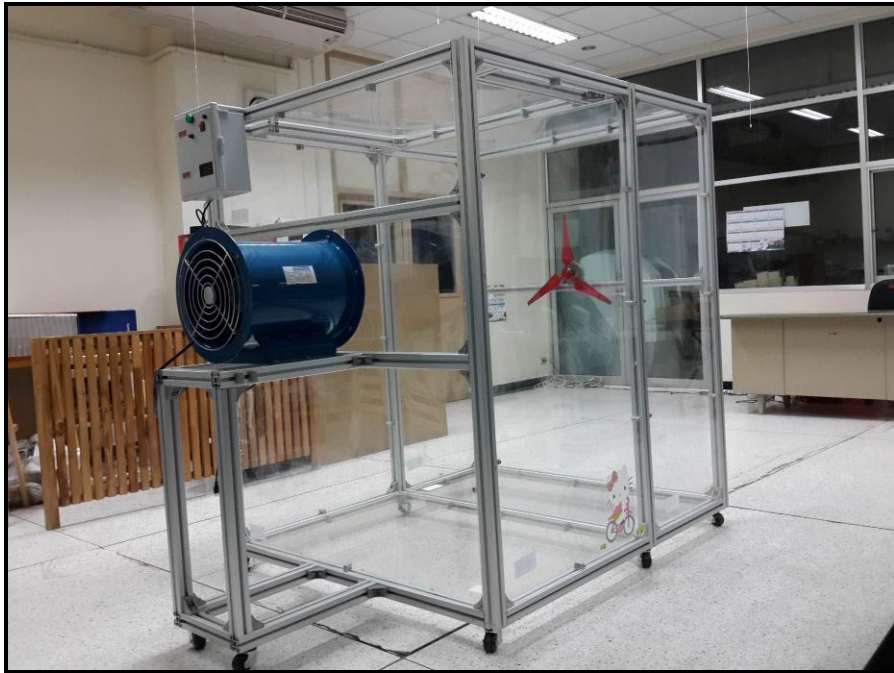
รูปที่ 3.2 ต้นแบบเครื่องทดสอบกังหันลมที่สามารถปรับรูปแบบความเร็วลมได้
