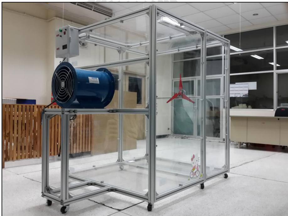
รูปที่ 4.1 ต้นแบบเครื่องทดสอบกังหันลมที่สามารถปรับรูปแบบความเร็วลมได้
