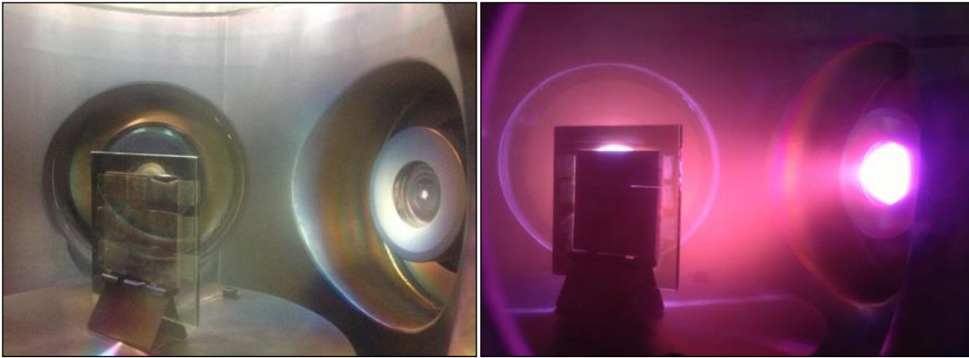
รูปที่ 3.7 ลักษณะคาโทด การวางชิ้นงาน และพลาสมาขณะเคลือบ
