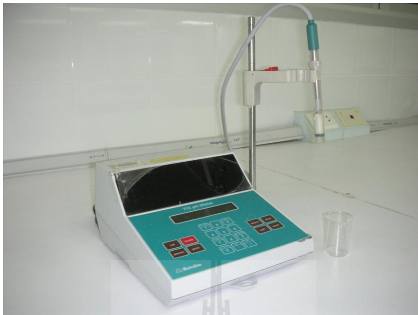
รูปที่ 3.7 เครื่องวัดค่าความเป็นกรด-ด่าง (pH meter) ในการวิจัย
