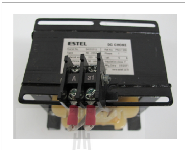
รูปที่ 6.23 ตัวเหนี่ยวนำของวงจรแปลงผันแบบบัคค์
