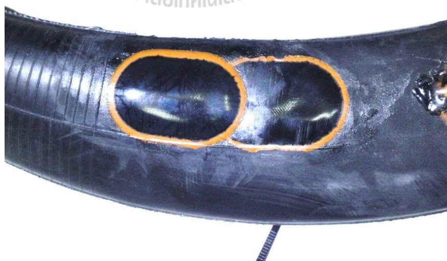
รูปที่ 7.14 การปะยางบริเวณที่ถูกตัด
