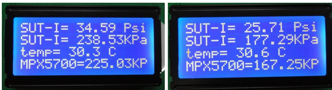
รูปที่ 7.17 ภาพการทดสอบตัวตรวจรู้ความดัน SUT-I และ MPX5700 ที่ติดตั้งภายในยางรถจักรยานยนต์ โดยส่งข้อมูลไร้สายจากชุดส่งสัญญาณภายในยางและแสดงผลผ่านจอ LCD ของชุดรับสัญญาณ
