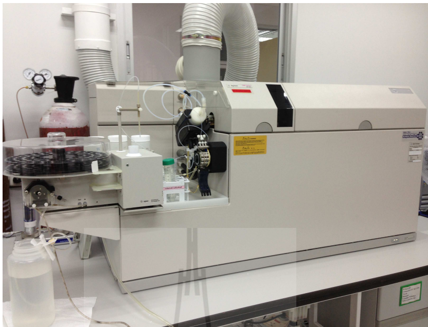
รูปที่ 3.6 เครื่องมือ Inductively Couple Plasma Mass Spectrometer (ICP-MS)
