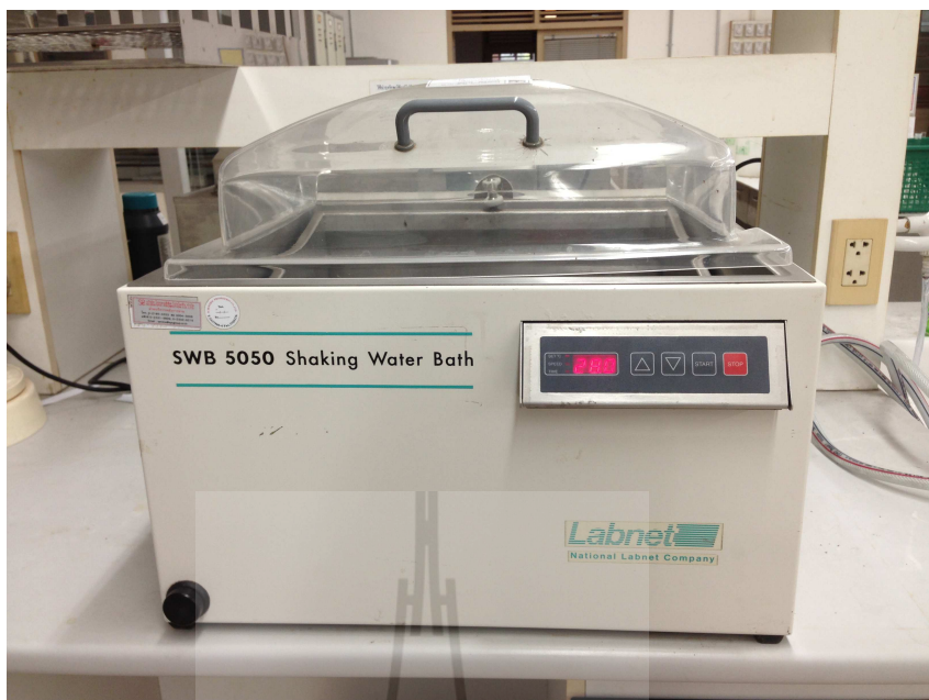
รูปที่ 3.4 เครื่องเขย่าแบบควบคุมอุณหภูมิ
