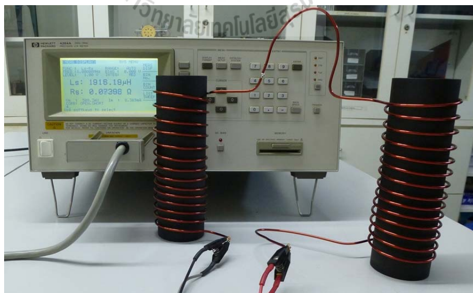
รูปที่ 4.6 รูปแบบการวัดค่าของขดลวดเหนี่ยวนำแบบสองขั้วที่ใช้เป็นตัวปล่อยคลื่นของระบบ
