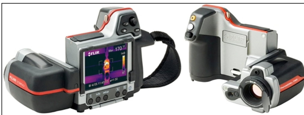
รูปที่ 4.11 ลักษณะรูปร่างของตัวกล้องถ่ายภาพความร้อน FLIR SYSTEMS รุ่น T360 (ภาพจากเว็บไซต์ของบริษัทเทอร์โมสแกน จำกัด; http://www.thermoscan.co.th )
