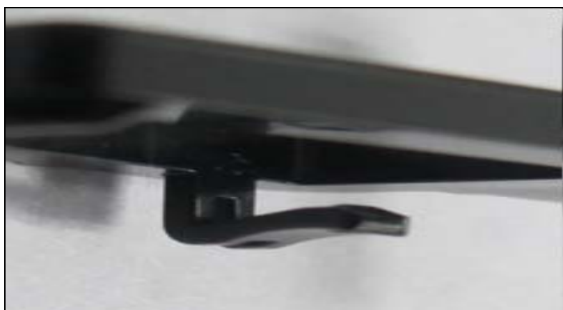
รูปที่ 3.6 แสดง Z-Latch ของหวี (Shipping Comb) ในการทำการวิจัยหาค่าแรง
