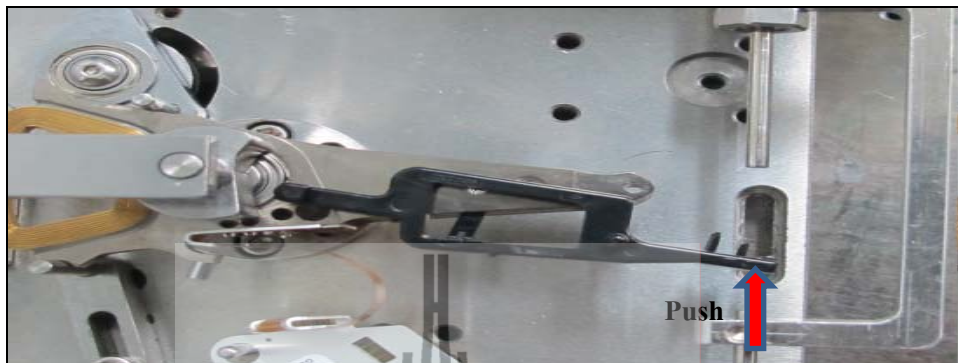
รูปที่ ก.6 แสดงลักษณะของการทดสอบค่าแรงสวมเข้าของหวี (Shipping Comb)
