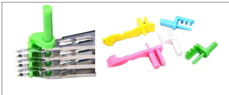
รูปที่ 2.6 แสดง Shipping Comb ตามจำนวนหัวอ่านขนาดต่าง ๆ
