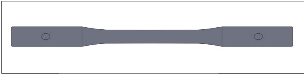
รูปที่ 3.11 แสดง Specimen ที่ได้จากการออกแบบด้วยโปรแกรม Solid Work 2011
