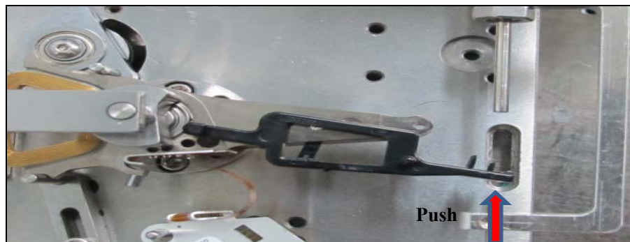
รูปที่ 3.10 แสดงลักษณะของการทดสอบค่าแรงสวมเข้าของหวี (Shipping Comb)
