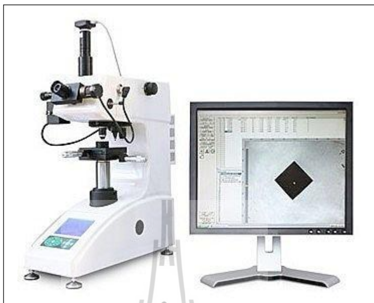
รูปที่ 2.14 แสดงเครื่องทดสอบความแข็งแบบวิกเกอร์ส
