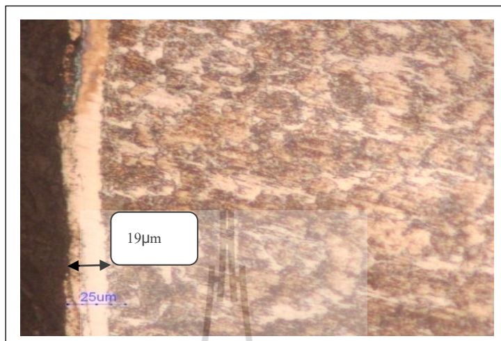
รูปที่ 4.3 แสดงโครงสร้างจุลภาคชั้นผิวขาวที่ผ่านกระบวนการแก๊สซอฟต์ไนไตรดิง 3
