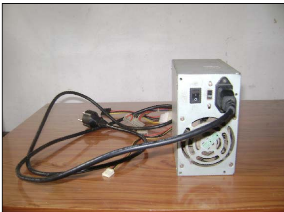
รูปที่ ก.8 แหล่งจ่ายไฟที่จ่ายให้กับวงจรควบคุมเมื่อถ่ายจากด้านหลัง
