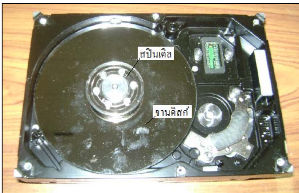
รูปที่ ก.3 ภายในของฮาร์ดดิสก์เมื่อมีจานดิสก์
