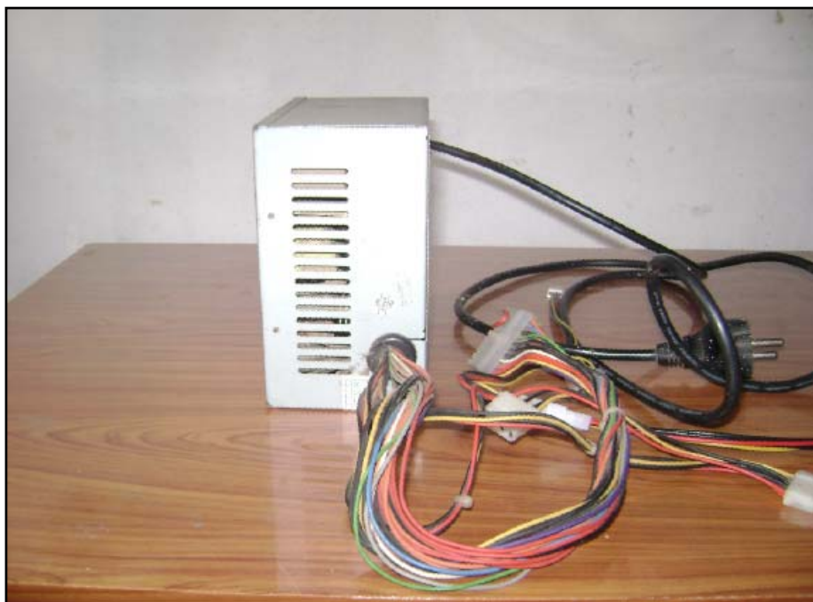
รูปที่ ก.7 แหล่งจ่ายไฟที่จ่ายให้กับวงจรควบคุมเมื่อถ่ายจากด้านหน้า
