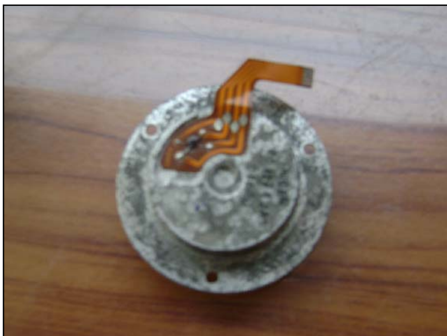
รูปที่ ก.6 สปินเดิลมอเตอร์เมื่อมองจากด้านสเตเตอร์
