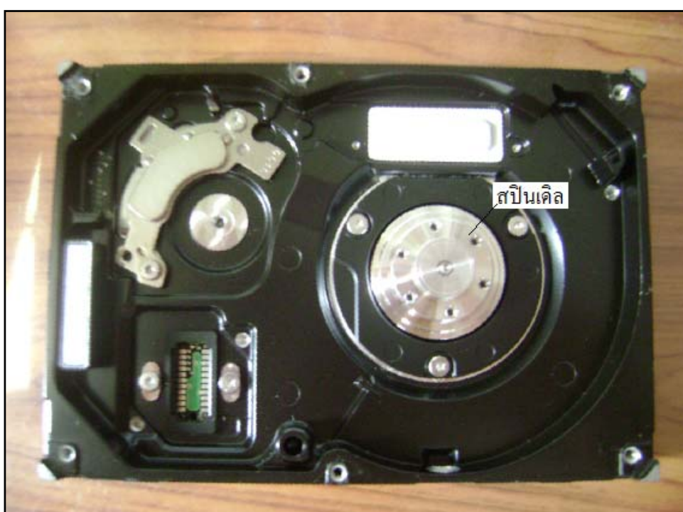
รูปที่ ก.4 ภายในของฮาร์ดดิสก์เมื่อไม่มีจานดิสก์
