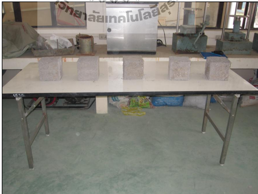
รูปที่ ค.2 แท่งตัวอย่างคอนกรีตบล็อก 60:40 W/B= 0.50
