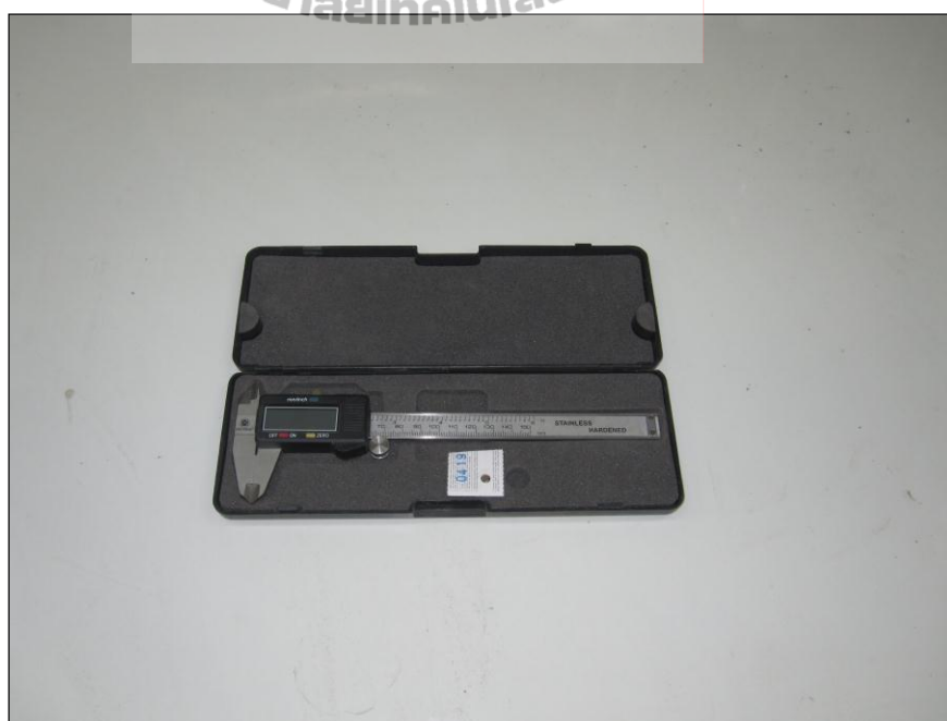
รูปที่ 3.8 เครื่องมือวัดขนาดแท่งตัวอย่างคอนกรีตบดลึอก (Venire)
