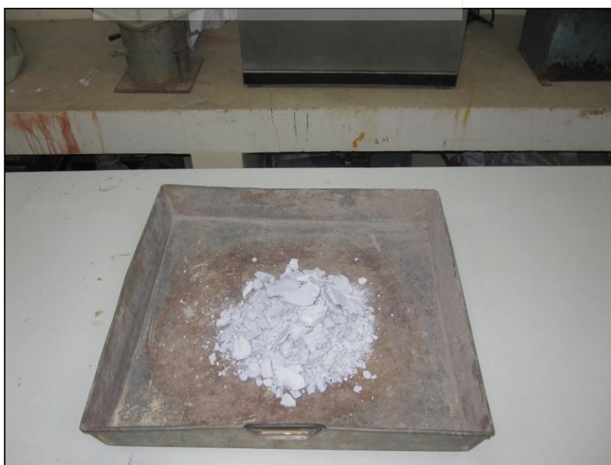
รูปที่ 3.1 ตัวอย่างกากแคลเซียมคาร์ไบด์ก่อนผสม
