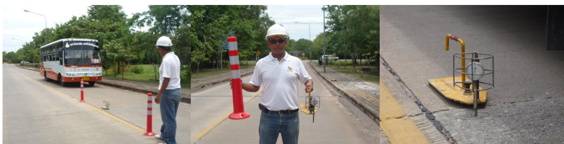
รูปที่ 3.4 การวัดค่าการทรุดตัวของแผ่นพื้นถนนคอนกรีตเสริมเหล็ก
