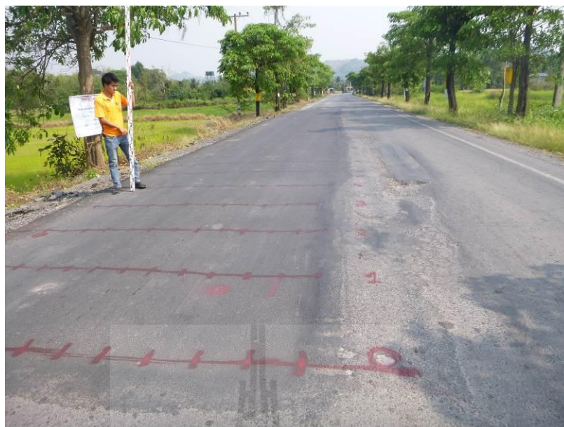
รูปที่ 4.11 ขั้นตอนการทำการหาค่าระดับในแนวขวางถนน
