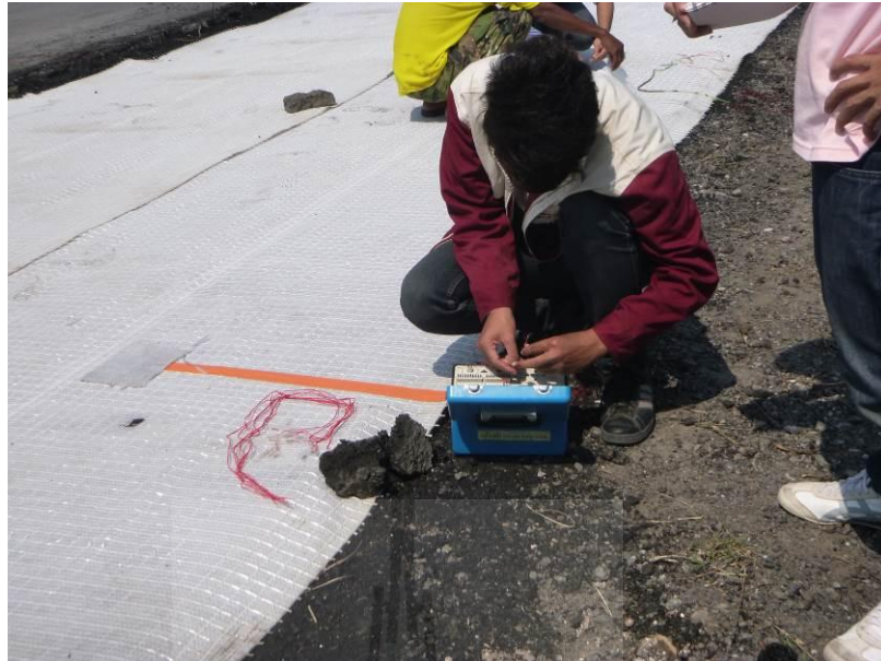
รูปที่ 4.9d ขั้นตอนการตรวจวัดค่า Strain Gauge
