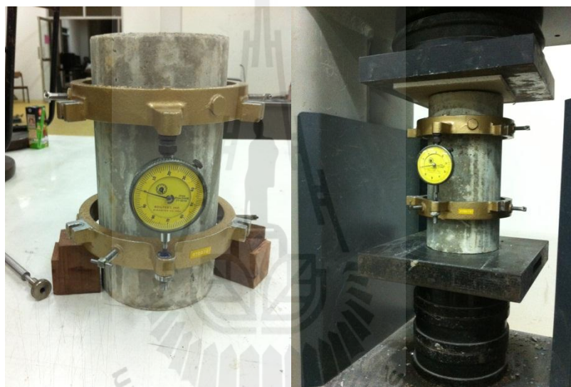
รูปที่ 3.12 ตัวอย่างทดสอบค่าโมดูลัสยืดหยุ่น (Compressometer)
