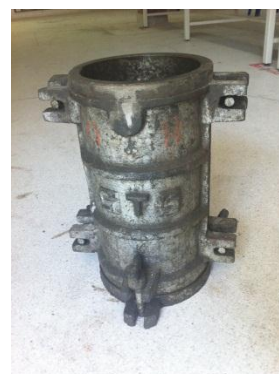
รูปที่ 3.6 แบบหล่อคอนกรีตรูปทรงลูกบาศก์ ขนาด 15×15×15 ซม. และ แบบหล่อคอนกรีตรูปทรงกระบอก ขนาด 0.15 × 0.30 ซม.
