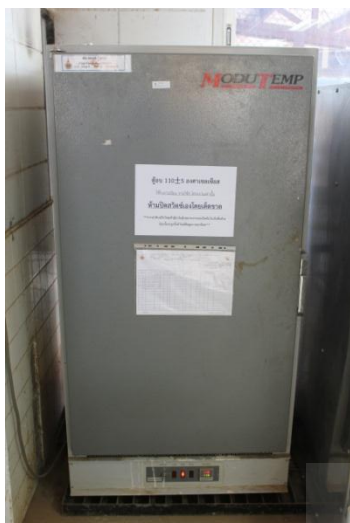
รูปที่ 3.4 ตู้อบควบคุมอุณหภูมิ 105 - 115 องศาเซลเซียส
