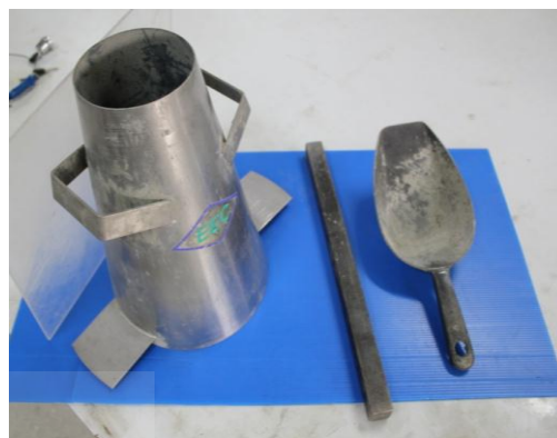
รูปที่ 3.5 ชุดทดสอบค่ายุบตัวของคอนกรีต
