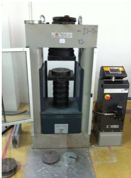
รูปที่ 3.8 เครื่องทดสอบกำลังอัดของคอนกรีต
