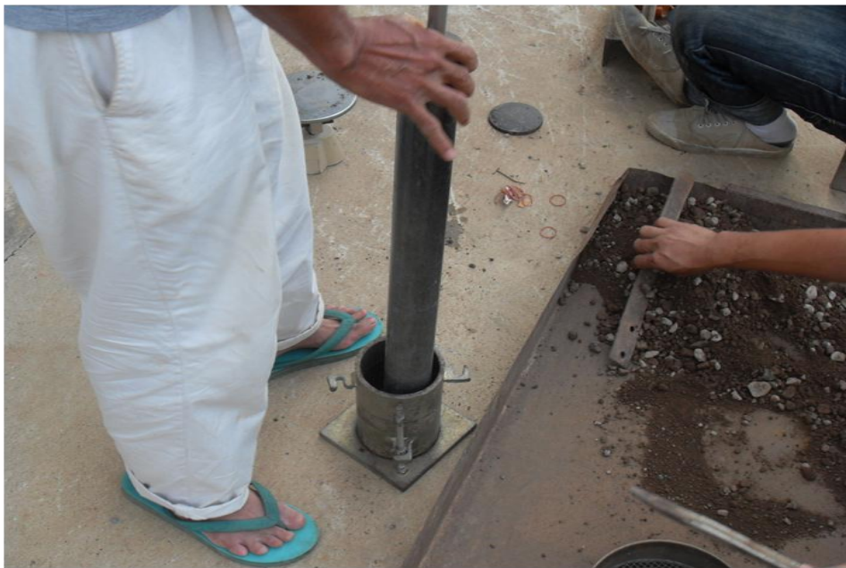
รูปที่ 3 บดอัดตัวอย่างหินคลุกซีเมนต์พื้นทางเดิมผสมผิวแอสฟัลต์คอนกรีตเดิม
