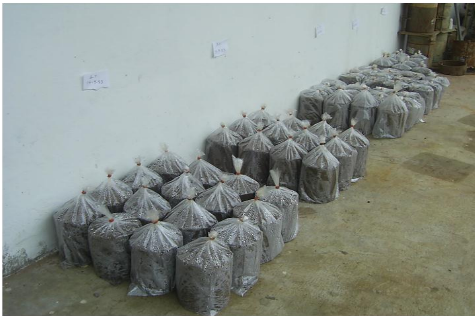
รูปที่ 5 บ่มตัวอย่างหินคลุกซีเมนต์พื้นทางเดิมผสมผิวแอสฟัลต์คอนกรีตเดิม
