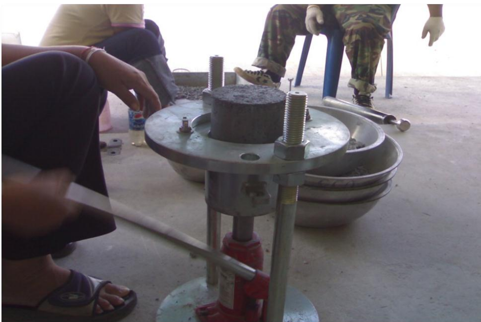
รูปที่ 4 ดันก้อนตัวอย่างหินคลุกซีเมนต์พื้นทางเดิมผสมผิวแอสฟัลต์คอนกรีตเดิม
