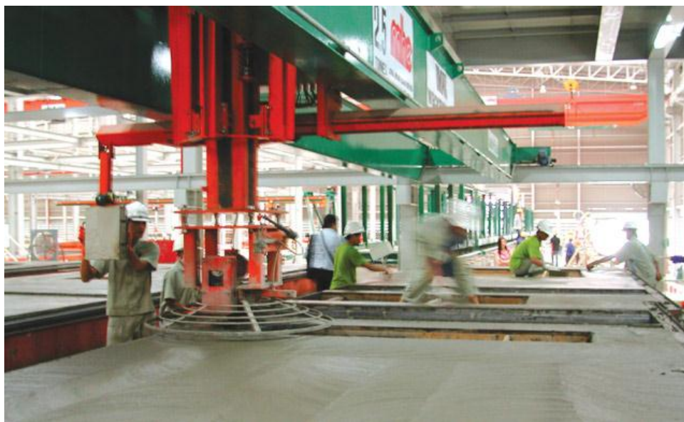
รูปที่ 2.8 การจัดผิวหน้าคอนกรีต ( Prukasa Real Estate , 2006)
