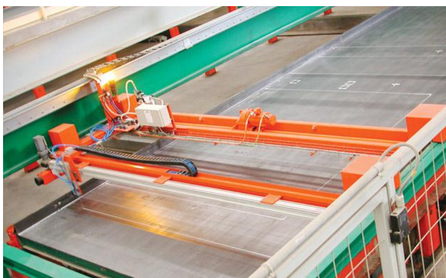
รูปที่ 2.3 การวางตำแหน่งอุปกรณ์ และของฝัง ( Pruksa Real Estate , 2006)
