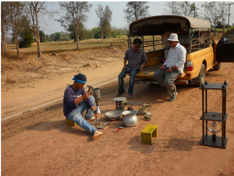
รูปที่ 3.2 การทดสอบความแน่นแข็งในสนาม ด้วยวิธีกรวยทราย
