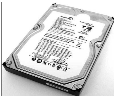
รูปที่ 2.1 ฮาร์ดดิสก์ไดฟ์ขนาด 3.5 นิ้วที่ใช้ในปัจจุบัน
