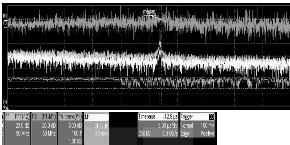
รูปที่ 4.8 ลักษณะของค่า pkp trend เมื่อหัวอ่านสัมผัสกับแผ่นดิสก์
