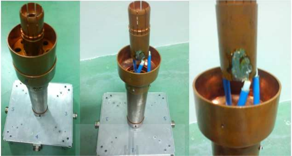
รูปที่ 4.48 แสดงจุดรอยต่อระหว่างสายนำสัญญาณแกนร่วมกับท่อทองแดงของพอร์ตที่ 1
