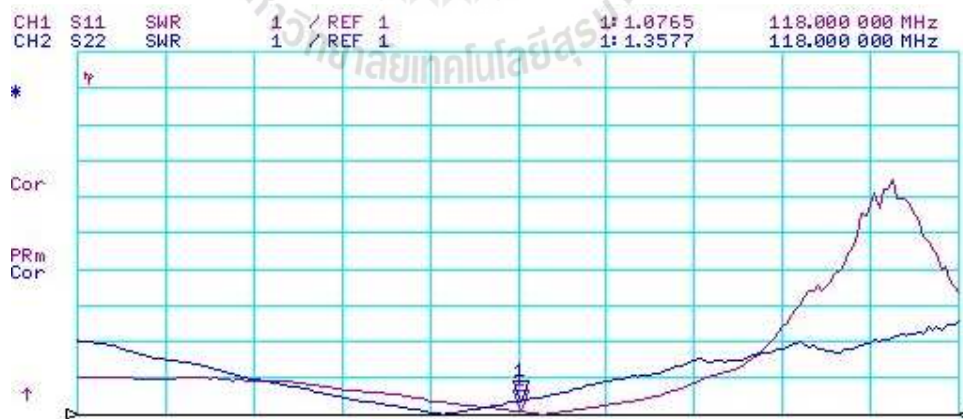
รูปที่ 4.27 แสดงค่า VSWR (Voltage Standing Wave Ratio) ของพอร์ตที่ 5 (CH1) และพอร์ตที่ 1 (CH2)
