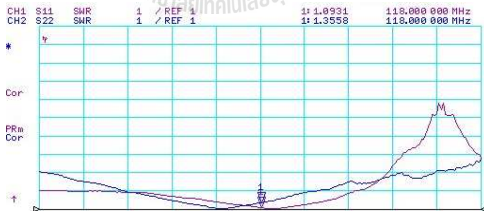
รูปที่ 4.13 แสดงค่า VSWR (Voltage Standing Wave Ratio) ของพอร์ตที่ 3 (CH1) และพอร์ตที่ 1 (CH2)
