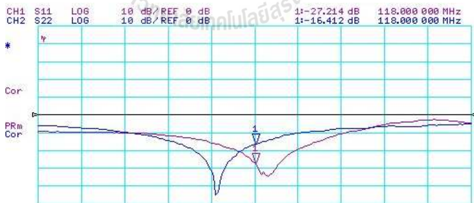
รูปที่ 4.11 แสดงความสัมพันธ์ระหว่างสัมประสิทธิ์การสะท้อนของทั้งสองพอร์ต เมื่อนำมาเปรียบเทียบในกราฟเดียวกัน
