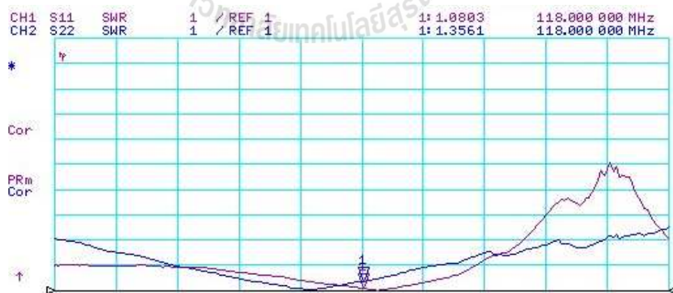
รูปที่ 4.20 แสดงค่า VSWR (Voltage Standing Wave Ratio) ของพอร์ตที่ 4 (CH1) และพอร์ตที่ 1 (CH2)
