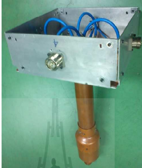
รูปที่ 3.12 ตัวรวมคลื่นต้นแบบที่สร้างตามที่ได้ออกแบบไว้
