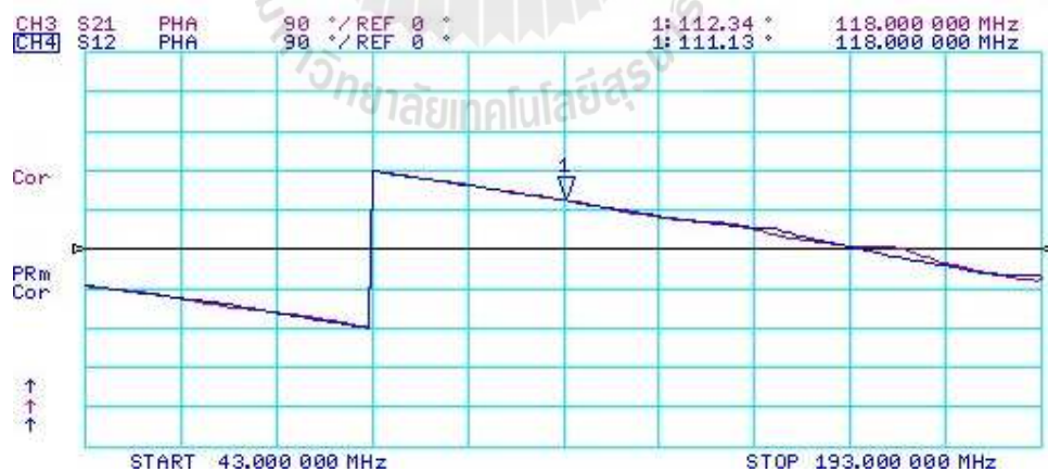
รูปที่ 4.22 แสดงค่ามุมเฟสระหว่างพอร์ตที่ 1 และพอร์ตที่ 4
