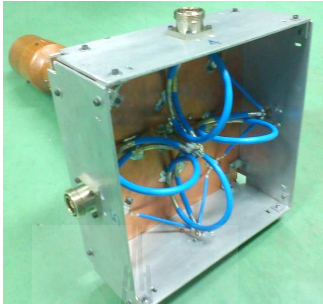
รูปที่ 3.13 ตัวรวมคลื่นต้นแบบที่สร้างตามที่ได้ออกแบบไว้
