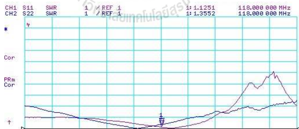
รูปที่ 4.6 แสดงค่า VSWR (Voltage Standing Wave Ratio) ของพอร์ตที่ 2 (CH1) และพอร์ตที่ 1 (CH2)
