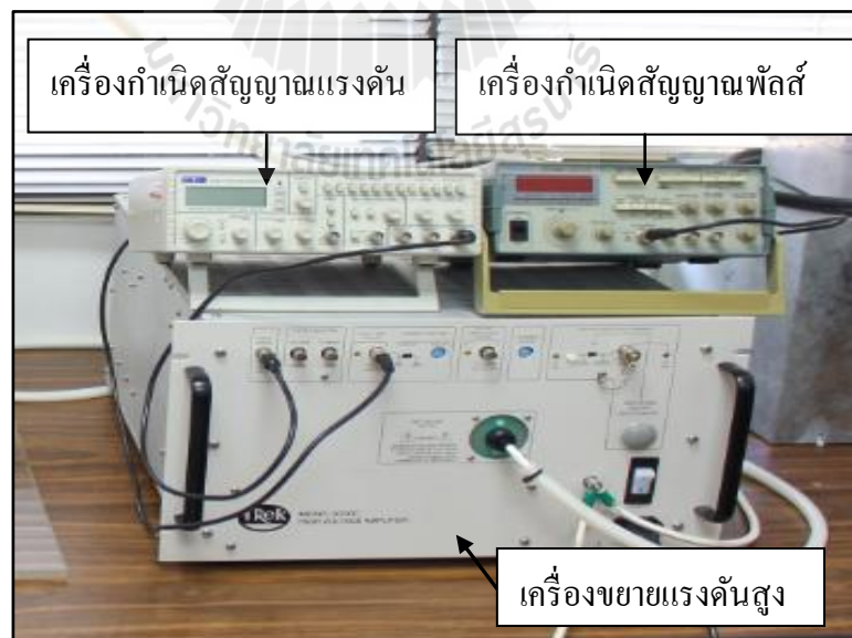
รูปที่ 4.5 อุปกรณ์ภาคแรงดันสูงและเครื่องกำเนิดสัญญาณ
