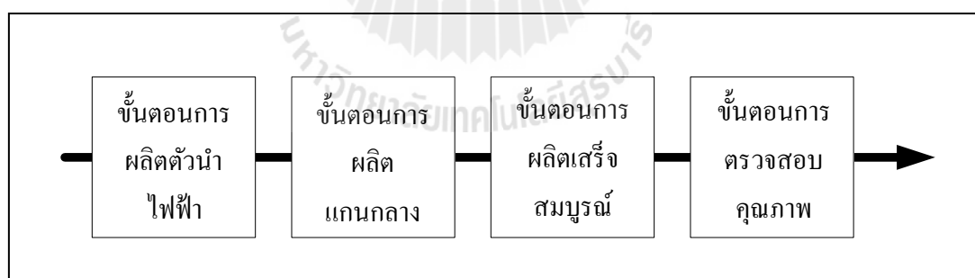
รูปที่ 3.12 ขั้นตอนการผลิตสายเคเบิลแรงสูงฉนวน XLPE
