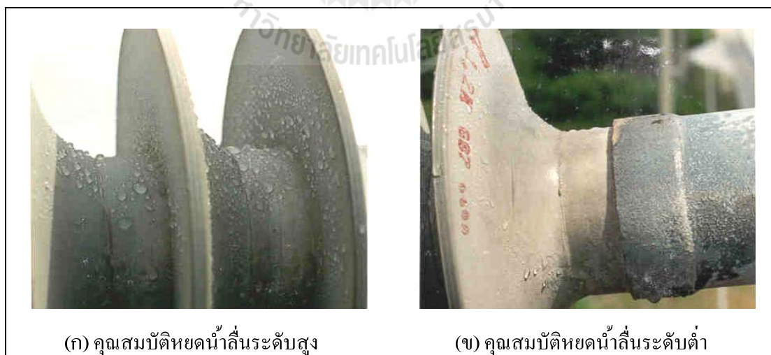
รูปที่ 3.10 การเกิดคุณสมบัติหยดน้ำบนพื้นผิวของซิลิโคน (Jeff, 1998)
