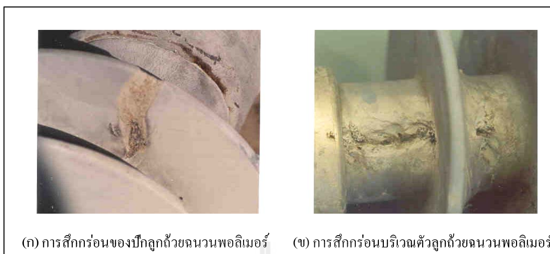
รูปที่ 3.17 การสีกร่อนของลูกถ้วยฉนวนพอลิเมอร์ (Jeff, 1998)
