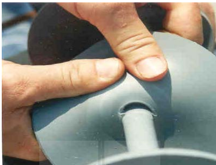
รูปที่ 3.12 การฉีกขาดบริเวณปีกลูกถ้วยฉนวนพอลิเมอร์ (Jeff, 1998)
