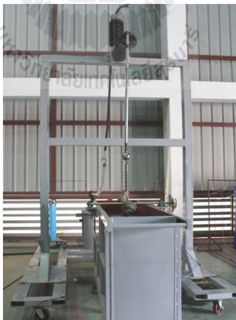
รูปที่ 4.8 ชุดทดสอบแรงการเสื่อมอายุของลูกถ้วยฉนวนพอลิเมอร์ที่ประกอบเสร็จ
