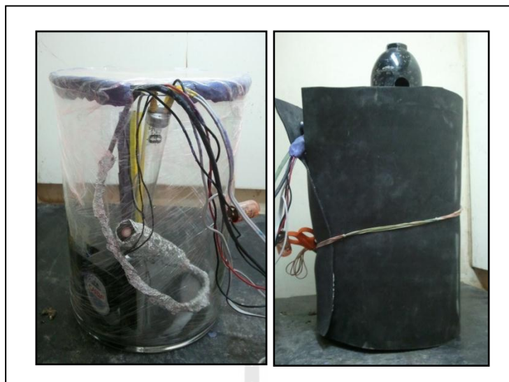
รูปที่ 4.12 ถังปฏิกิริยาที่ทำจากโพลีเอทิลีน
