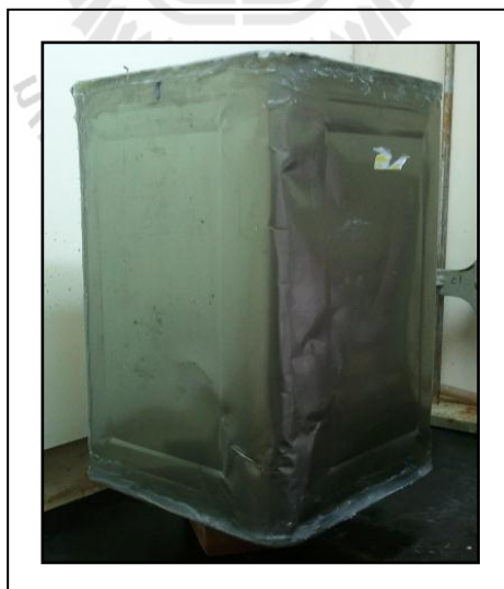
รูปที่ 4.17 ถังปฏิกิริยาที่ทำจากปั๊มเหล็กเคลือบดีบุก
