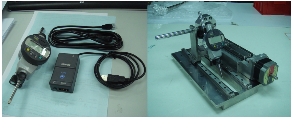
รูปที่ 5.10 การติดตั้งคู่อัดเกจสำหรับวัดความโค้ง
