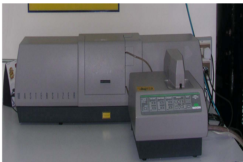
รูปที่ 3.2 เครื่องวิเคราะห์ขนาดอนุภาคระบบเลเซอร์ (laser particle size analyzer)
