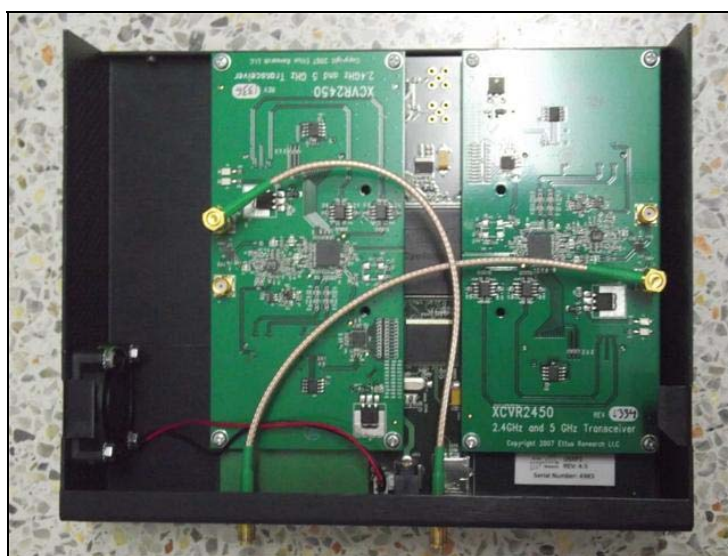
รูปที่ 4.17 ชุดอุปกรณ์ที่รองรับการทำงานแบบโมโม
