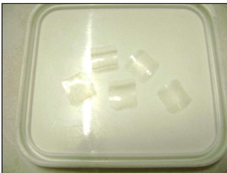
รูปที่ 4.3 ชิ้นงาน XLPE ที่ถูกตัดด้วยเครื่องไมโครโทม
