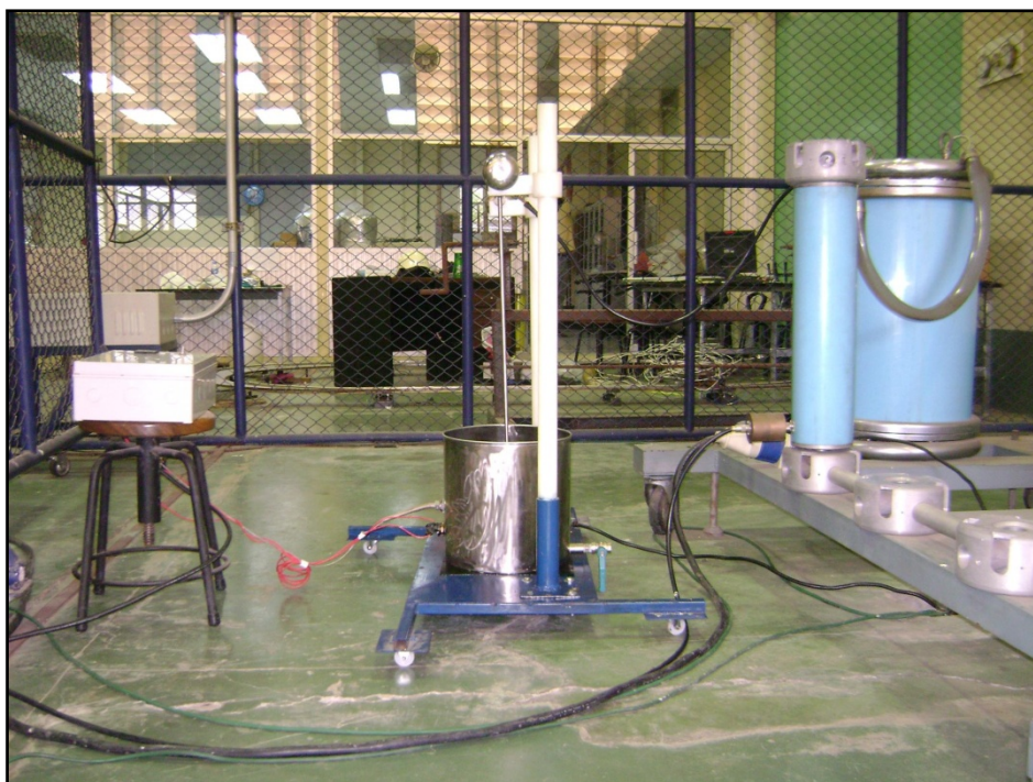
รูปที่ 4.8 ระบบชุดทดสอบการเสื่อมอายุ
