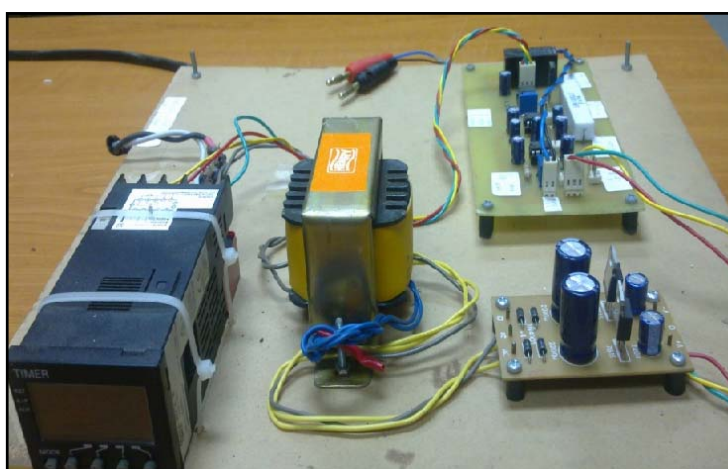
รูปที่ 4.7 วงจรถามเวลาการแรงเสื่อมอายุของชิ้นงาน XLPE
