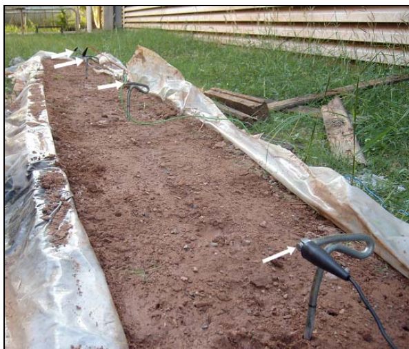
รูปที่ 4.11 กระบะดินทดสอบค่าสภาพความต้านทานดิน
