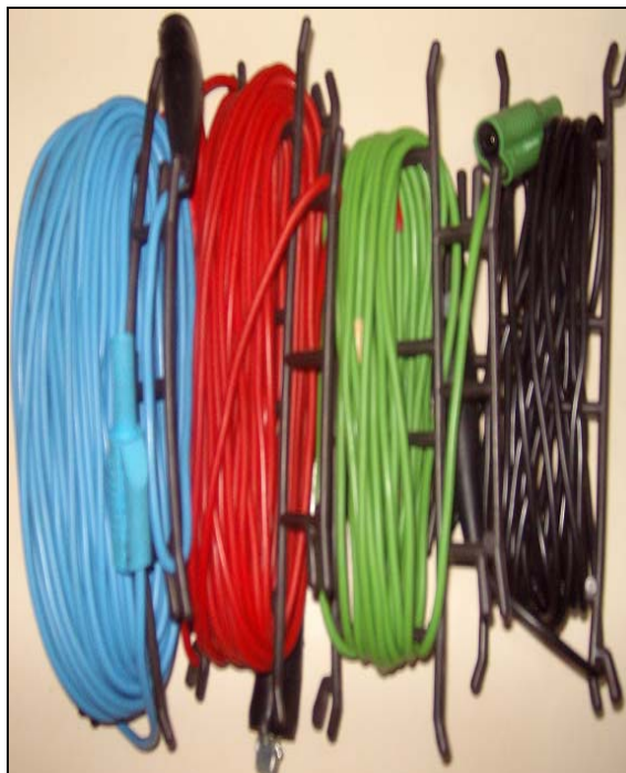
รูปที่ ง.2 สายไฟสำหรับวัดค่าสภาพความต้านทานดิน
