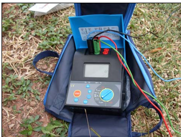
รูปที่ 3.8 เครื่องวัดค่าสภาพความต้านทานดิน METREL Earth Tester รุ่น MI 2124
