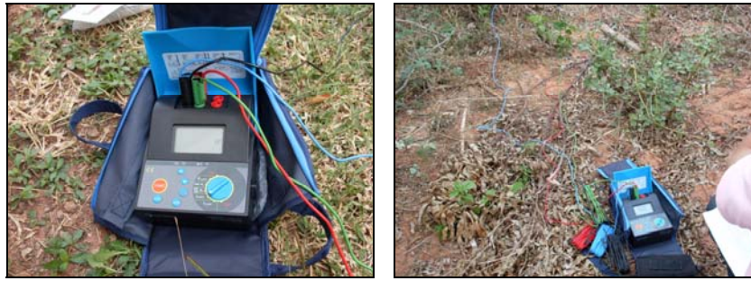
รูปที่ ค.34 เครื่องวัดค่าสภาพความต้านทานดิน METREL earth tester รุ่น MI 2124
