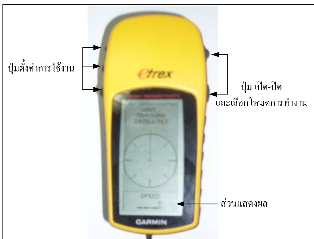
รูปที่ ง.6 เครื่องวัดพิกัดภูมิศาสตร์ Etrex H
