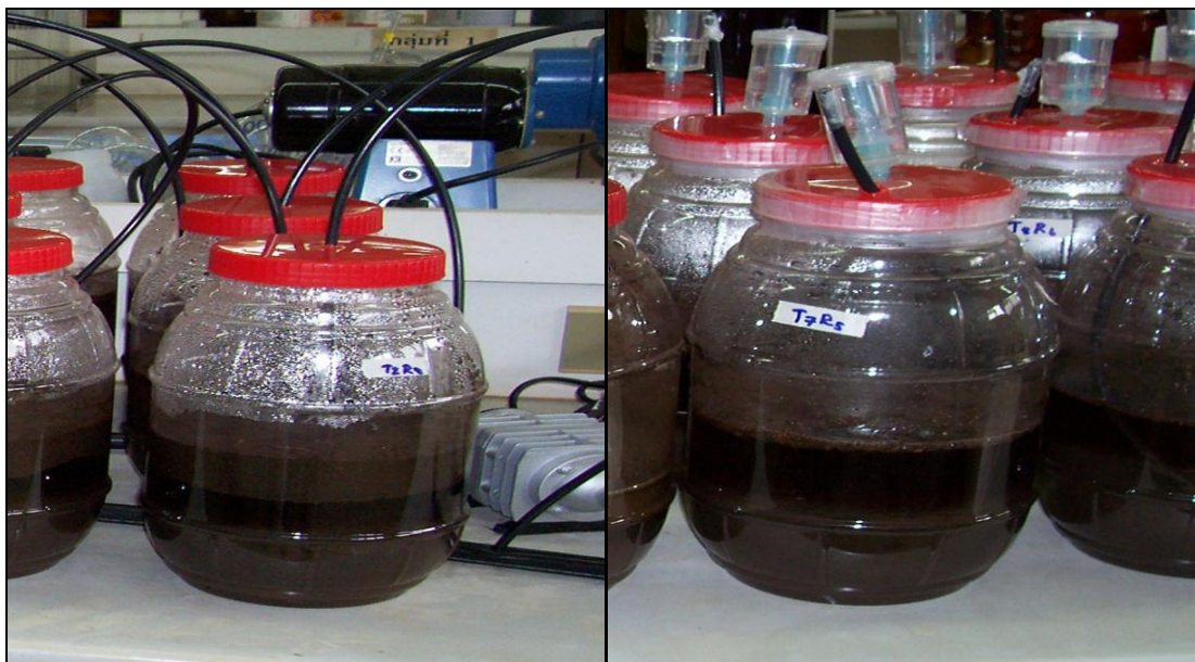
ภาพภาคผนวกที่ 1 การหมักปุ๋ยอินทรีย์น้ำแบบมีอากาศ (ซ้าย) และไม่มีอากาศ (ขวา)
