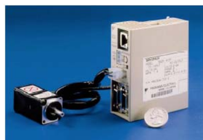
รูปที่ 3 เซอร์โวมอเตอร์ของบริษัท YASKAWA รุ่น SGMM-A2C312
