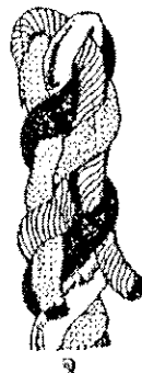
รูปที่ 2.5 ใช้เส้นย่อยแต่ละเส้นข้ามเส้นที่ขวางหน้าแล้วสอดเข้าใต้เส้นที่ถัดไป ทำเช่นนี้จนครบ 2 - 3 รอบ
