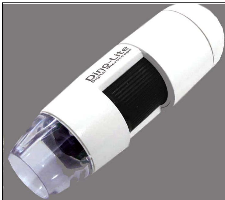
รูปที่ 3.11 กล้อง digital microscope ที่ใช้ในเครื่องมือตรวจสอบสกรู
