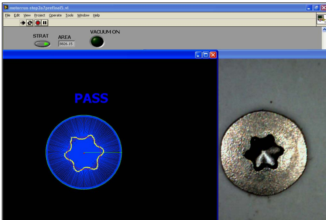
รูปที่ 4.5 การทำงานของโปรแกรมการประมวลผลภาพกรณี pass
