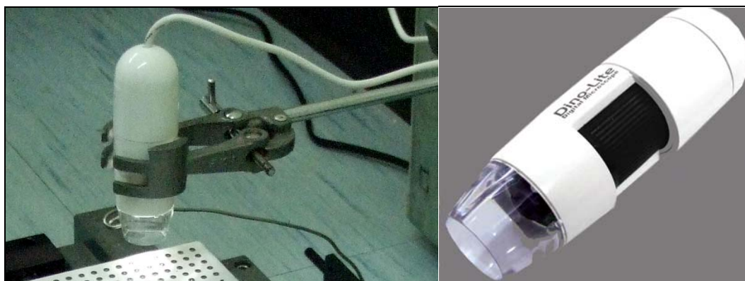
รูปที่ ก.4 การติดตั้งกล้องเพื่อเป็นตัวรับภาพของระบบ
