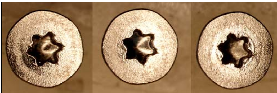
รูปที่ 3.5 ลักษณะของสกรูที่สามารถนำกลับไปใช้งานได้ (accept)
