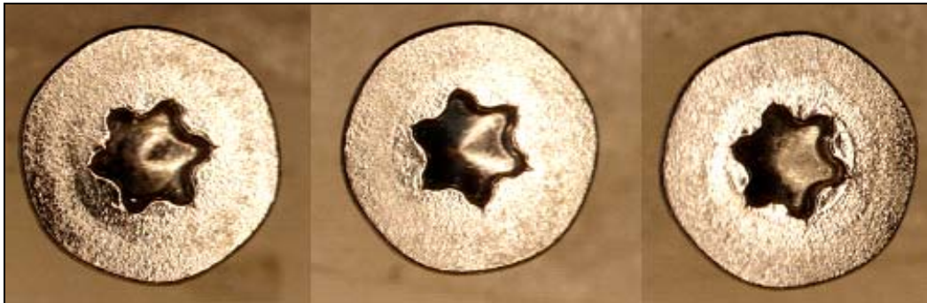
รูปที่ 3.4 ลักษณะของสกรูที่ไม่สามารถนำกลับไปใช้งานได้ (reject)
