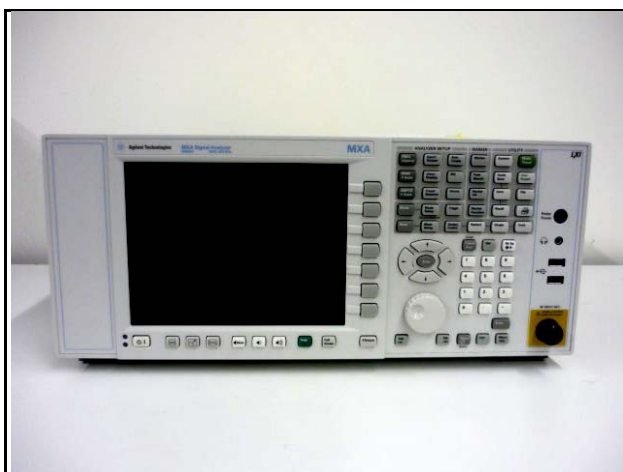
รูปที่ 3.18 เครื่องรับ Agilent N9020A MXA signal analyzer
