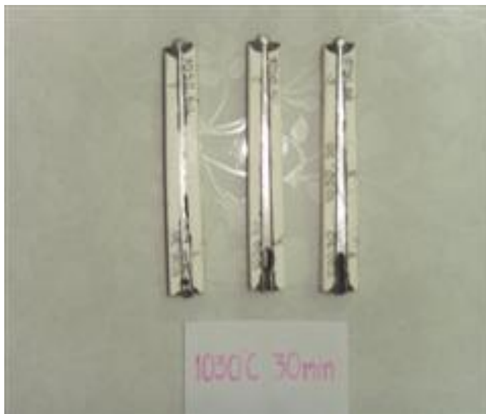
รูปที่ ก.7 แสดงวัสดุเชิงประกอบอะลูมินา-อะลูมินีเยม แบบอัดซ้อน โดยใช้แผ่นอะลูมินีเยมอัลลอยด์เกรด 6063-0 หนา 2 มิลลิเมตร ที่อุณหภูมิ 1050 °C เวลา 30 นาที หลังการทดสอบความทนต่อการดัดโค้ง
