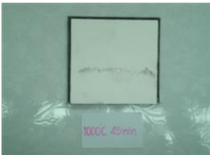
รูปที่ 4.21(ก) แสดงวัสดุเชิงประกอบอะลูมินา-อะลูมิเนียม แบบอัดร้อน ที่ผ่านการเผาประสาน
