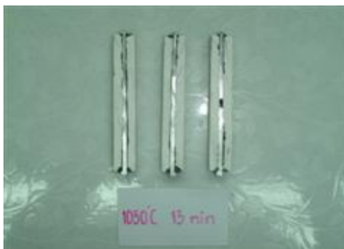
รูปที่ 4.22(ข) แสดงวัสดุเชิง ประกอบ อะลูมินา-อะลูมิเนียม ที่ผ่านการตัดก่อนการทดสอบ
