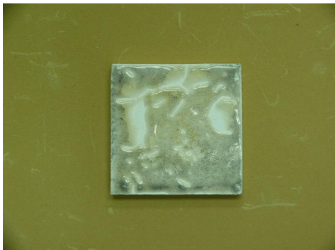
รูปที่ 4.8(ก) แสดงการเผาเคลือบด้วยฟริตที่มีจุดสุกตัวต่ำ กับแผ่นอะลูมินา ที่อุณหภูมิ 1000 องศาเซลเซียส เวลา 30 นาที (Frit-1000)
