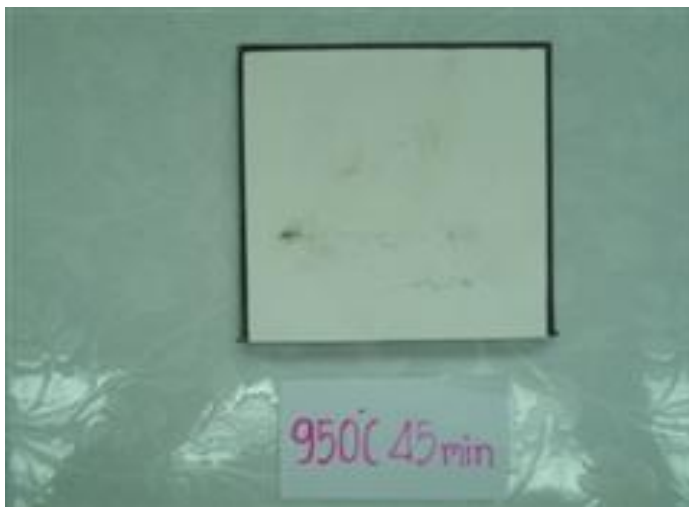
รูปที่ 4.18(ก) แสดงวัสดุเชิงประกอบอะลูมินา-อะลูมิเนียม แบบอัดขึ้น ที่ผ่านการเผาประสาน
