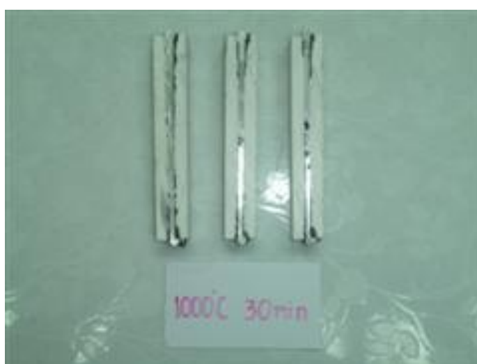
รูปที่ 4.20(ข) แสดงวัสดุเชิง ประกอบ อะลูมินา -อะลูมิเนียม ที่ผ่านการตัดก่อนการทดสอบ
