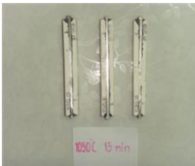
รูปที่ ก.6 แสดงวัสดุเชิงประกอบอะลูมินา-อะลูมิเนียม แบบอัดซ้อน โดยใช้แผ่นอะลูมิเนียมอัลลอยด์เกรด 6063-0 หนา 2 มิลลิเมตร ที่อุณหภูมิ 1050 °C เวลา 15 นาที หลังการทดสอบความทนต่อการดัดโค้ง
