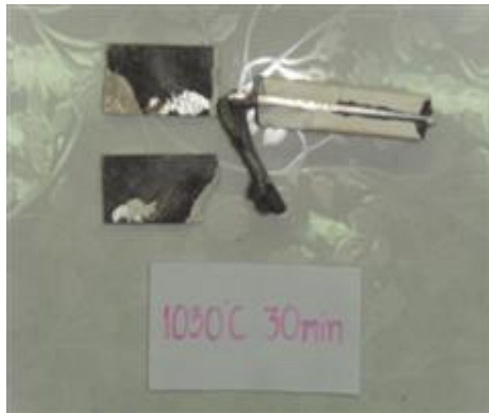
รูปที่ ก.15 แสดงวัสดุเชิงประกอบอะลูมินา -อะลูมิเนียม แบบอัดซ้อน โดยใช้แผ่นอะลูมิเนียม อัลลอยด์เกรด 6063-0 หนา 2 มิลลิเมตร ที่อุณหภูมิ 1050 °C เวลา 30 นาที หลังการทดสอบความต้านทานแรงกระแทก
