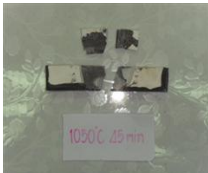
รูปที่ ก.16 แสดงวัสดุเชิงประกอบอะลูมินา -อะลูมิเนียม แบบอัดซ้อน โดยใช้แผ่นอะลูมิเนียม อัลลอยด์เกรด 6063- 0 หนา 2 มิลลิเมตร ที่อุณหภูมิ 1050 °C เวลา 45 นาที หลังการทดสอบความต้านทานแรงกระแทก
