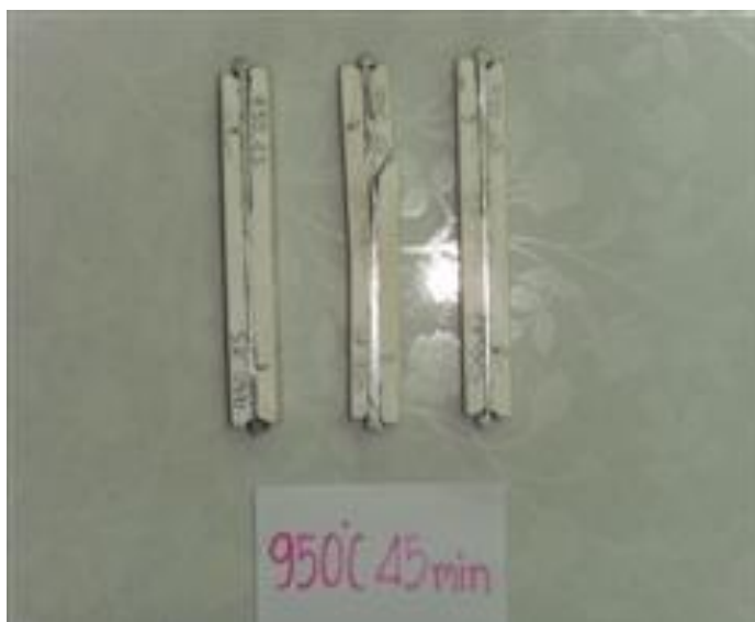
รูปที่ ก.2 แสดงวัสดุเชิงประกอบอะลูมินา-อะลูมิเนียม แบบอัดซ้อน โดยใช้แผ่นอะลูมิเนียมอัลลอยด์เกรด 6063-0 หนา 2 มิลลิเมตร ที่อุณหภูมิ 950 °C เวลา 45 นาที หลังการทดสอบ ความทนต่อการดัดโค้ง
