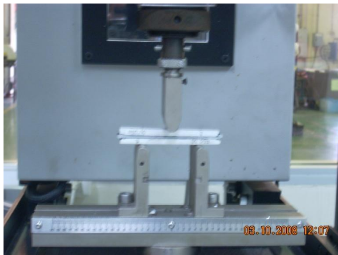
รูปที่ 3.13 แสดงลักษณะการวางชิ้นงานบนเครื่อง Universal testing machine
