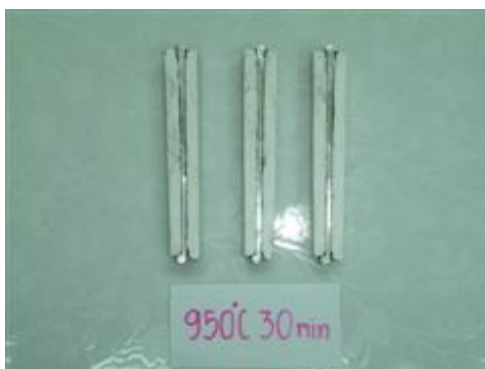
รูปที่ 4.17(ข) แสดงวัสดุเชิงประกอบอะลูมินาอะลูมิเนียม ที่ผ่านการตัดก่อนการทดสอบแล้วหลักร้อน
