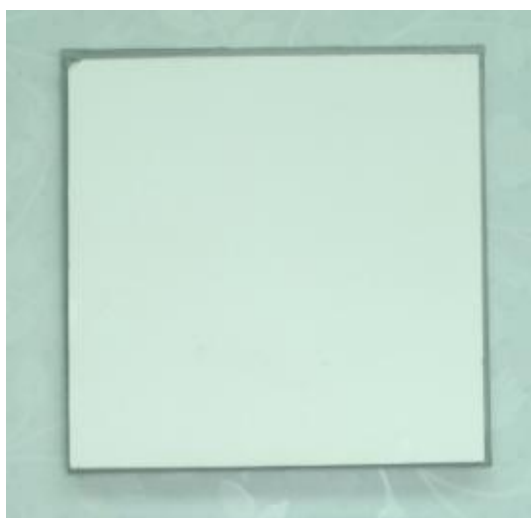
รูปที่ 3.10 แสดงวัสดุเชิงประกอบอะลูมินา-อะลูมิเนียม ออกไซด์แบบ 3 ชั้น ที่ผ่านการเผาประสานที่อุณหภูมิ 950 องศาเซลเซียส เวลา 45 นาที
