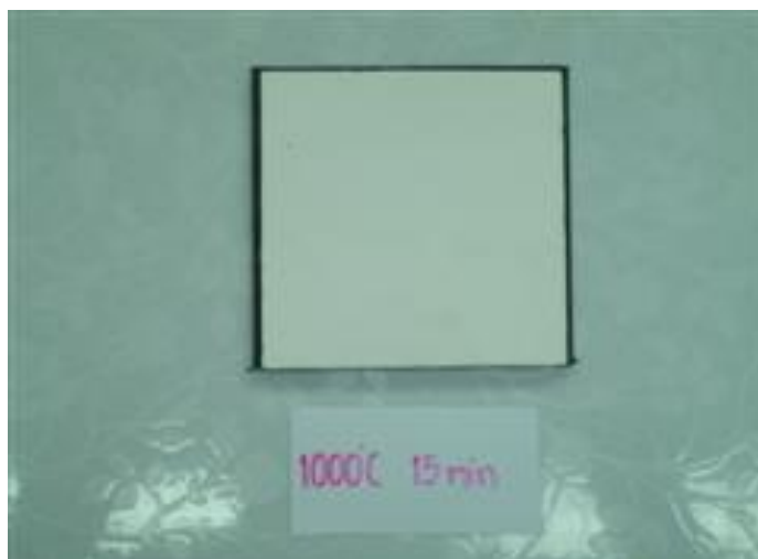
รูปที่ 4.19(ก) แสดงวัสดุเชิงประกอบอะลูมินา-อะลูมิเนียม แบบอัดขึ้น ที่ผ่านการเผาประสาน
