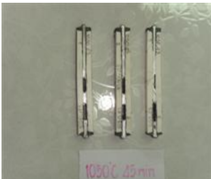
รูปที่ ก.8 แสดงวัสดุเชิงประกอบอะลูมินา-อะลูมินีเยม แบบอัดซ้อน โดยใช้แผ่นอะลูมินีเยมอัลลอยด์เกรด 6063-0 หนา 2 มิลลิเมตร ที่อุณหภูมิ 1050 °C เวลา 45 นาที หลังการทดสอบความทนต่อการดัดโค้ง
