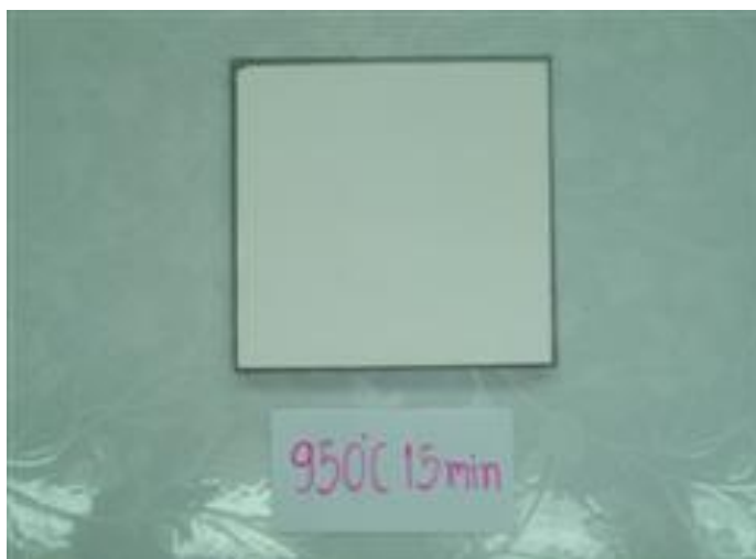
รูปที่ 4.16(ก) แสดงวัสดุเชิงประกอบอะลูมินา-อะลูมิเนียม แบบอัดขึ้น ที่ผ่านการเผาประสาน
