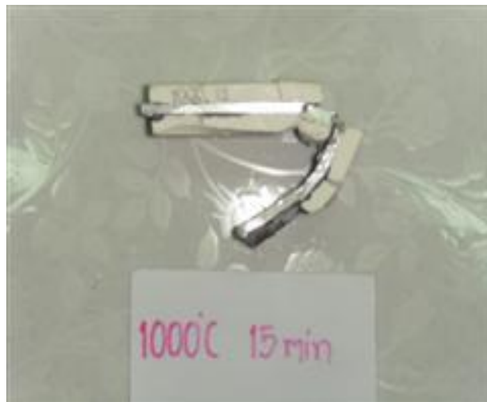
รูปที่ ก.11 แสดงวัสดุเชิงประกอบอะลูมินา -อะลูมิเนียม แบบอัดซ้อน โดยใช้แผ่นอะลูมิเนียม อัลลอยด์เกรด 6063- 0 หนา 2 มิลลิเมตร ที่อุณหภูมิ 1000 °C เวลา 15 นาที หลังการทดสอบความต้านทานแรงกระแทก
