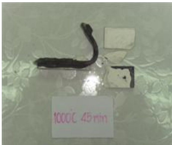
รูปที่ ก.13 แสดงวัสดุเชิงประกอบอะลูมินา -อะลูมิเนียม แบบอัดซ้อน โดยใช้แผ่นอะลูมิเนียม อัลลอยด์เกรด 6063- 0 หนา 2 มิลลิเมตร ที่อุณหภูมิ 1000 °C เวลา 45 นาที หลังการทดสอบความต้านทานแรงกระแทก
