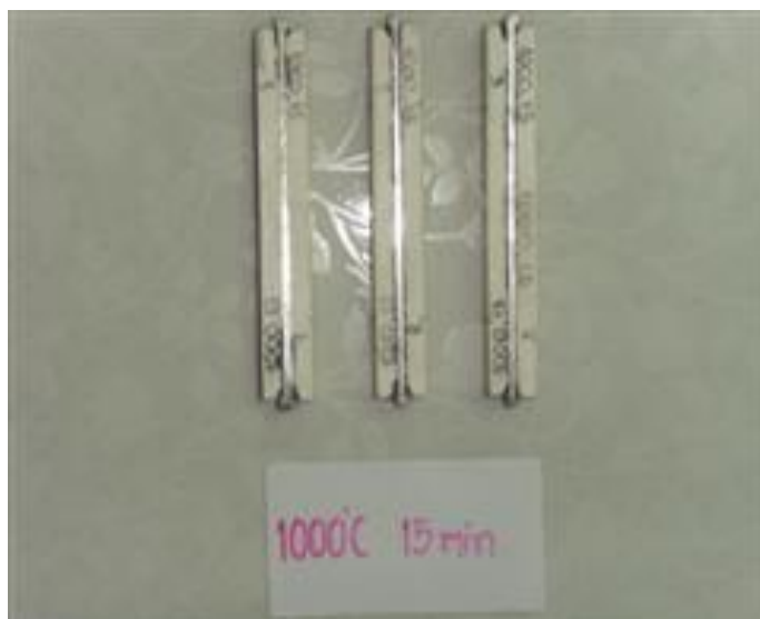
รูปที่ ก.3 แสดงวัสดุเชิงประกอบอะลูมินา-อะลูมิเนียม แบบอัดซ้อน โดยใช้แผ่นอะลูมิเนียมอัลลอยด์เกรด 6063-0 หนา 2 มิลลิเมตร ที่อุณหภูมิ 1000 °C เวลา 15 นาที หลังการทดสอบความทนต่อการตัดโค้ง
