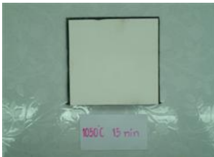
รูปที่ 4.22(ก) แสดงวัสดุเชิงประกอบอะลูมินา-อะลูมิเนียม แบบอัดขึ้น ที่ผ่านการเผาประสาน
