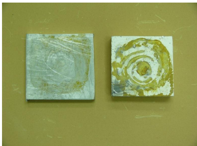
รูปที่ 4.10 แสดงวัสดุเชิงประกอบอะลูมินาอะลูมิเนียม แบบอัดซ้อน ที่ผ่านการเผาประสานที่อุณหภูมิ 350 องศาเซลเซียส เวลา 30 นาที ภายใต้บรรยากาศอาร์กอน โดยใช้แผ่นอะลูมิเนียมอัลลอยด์ เกรด 6063-0 หนา 6 มิลลิเมตร และใช้ตะกั่ว หนา 1 มิลลิเมตร วางกั้นอยู่ตรงกลาง (A16063-Pb-350)
