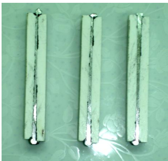
รูปที่ 3.11 แสดงตัวอย่างทดสอบที่ผ่านการตัดด้วยเครื่องตัดใบตัดเพชร
