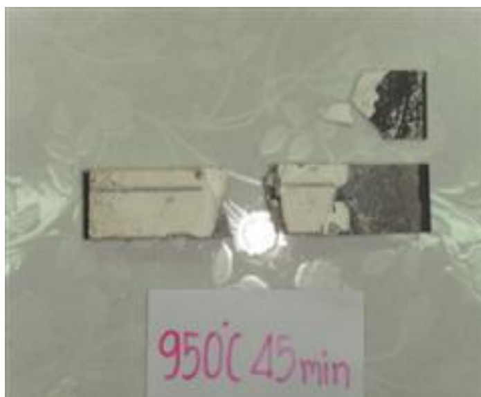
รูปที่ ก.10 แสดงวัสดุ เชิงประกอบอะลูมินา -อะลูมิเนียม แบบอัดซ้อน โดยใช้แผ่นอะลูมิเนียม อัลลอยด์เกรด 6063- 0 หนา 2 มิลลิเมตร ที่อุณหภูมิ 950 °C เวลา 45 นาที หลังการทดสอบความต้านทานแรงกระแทก
