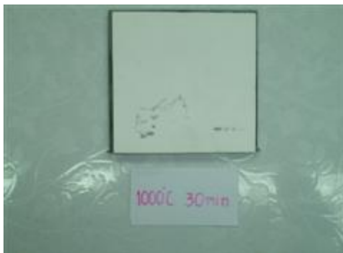
รูปที่ 4.20(ก) แสดงวัสดุเชิงประกอบอะลูมินา-อะลูมิเนียม แบบอัดขึ้น ที่ผ่านการเผาประสาน
