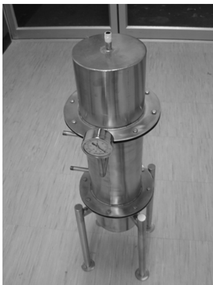
รูปที่ 3.9 อุปกรณ์ควบแน่น
