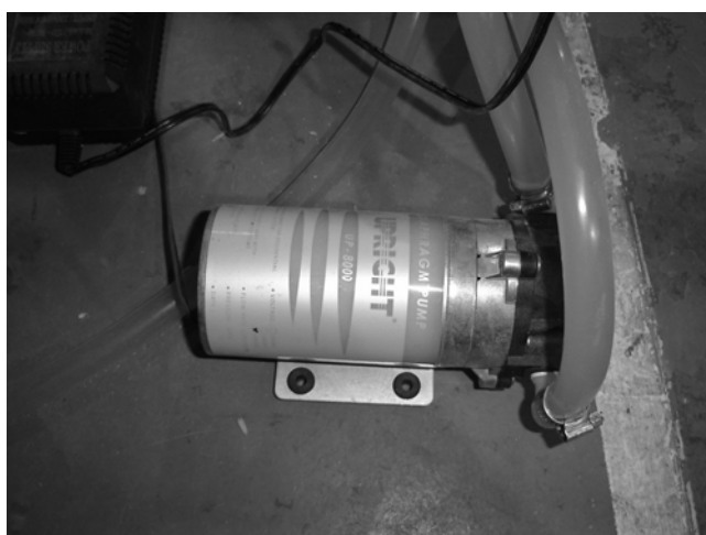
รูปที่ 3.17 ปั๊มไดอะแฟรม อัตราการไหล 4 L·min -1
