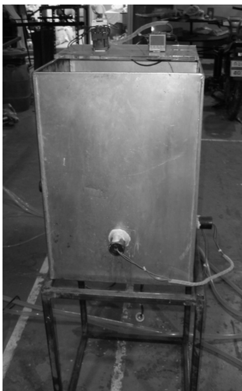
รูปที่ 3.15 ชุดสร้างภาระความร้อนให้อุปกรณ์ทำระเหย
