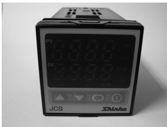
รูปที่ 3.6 อุปกรณ์ควบคุมอุณหภูมิ
