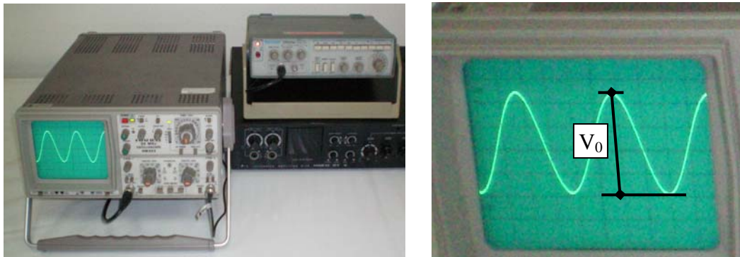
รูปที่ 3.6 แสดงลักษณะเครื่องมือ และวิธีการอ่านค่า Amplitude ( V_0 )
